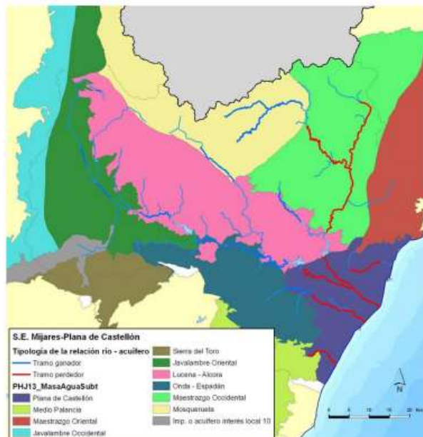
Figura 17. Relación río acuífero en el sistema de explotación Mijares-Plana de Castellón
