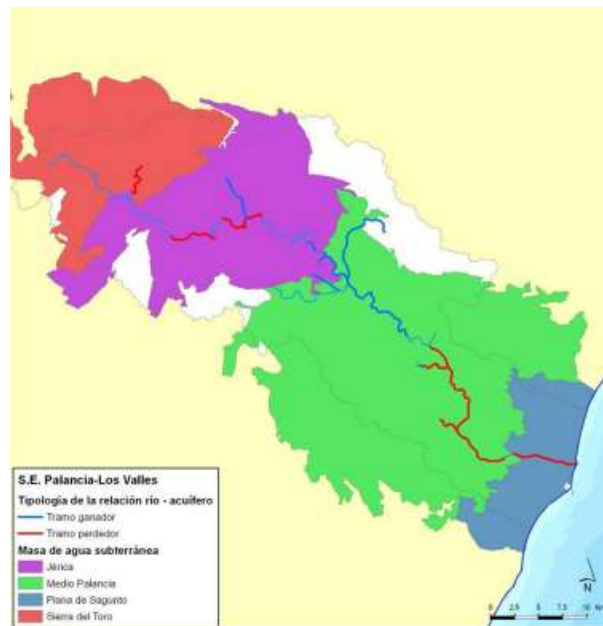
Figura 18. Relación río acuífero en el sistema de explotación Palancia-Los Valles
