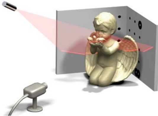
Fig. 15. Sistema de escáner 3D mediante láser de línea. Fuente: David Laser ( www.david-laserscanner.com )
