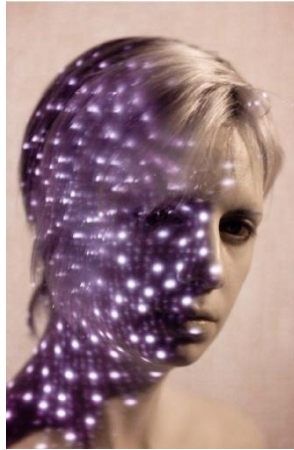
Fig 14. Patrón de luz IR generado por Kinect captado por una cámara CMOS
