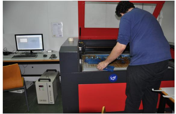
Figs. 52 y 53. Proceso de corte del metacrilato.
