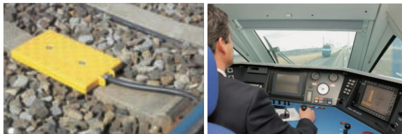
Foto 11. Baliza en vía y pupitre en cabina. Fuente: ADIF.
