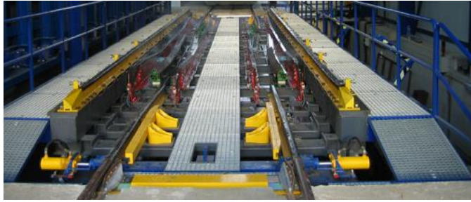
Foto 6. Cambio automático de ancho. Fuente: ADIF.
