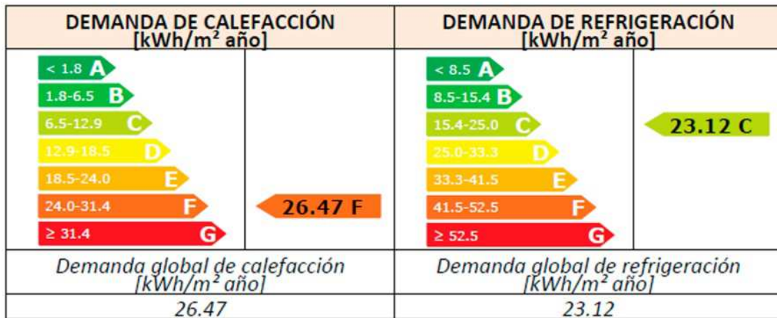
Figura 93. Calificación energética con cambio de ventanas en zonas este y oeste. Edificio 3N.
