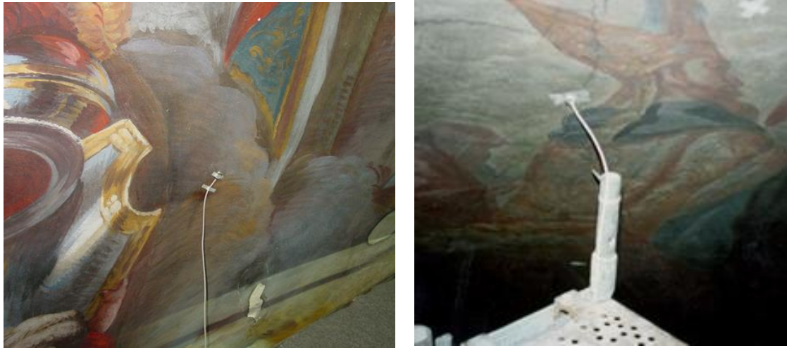
Figura 4.9. Sensores de T^a superficial sobre fresco A. Palomino. Basílica.
