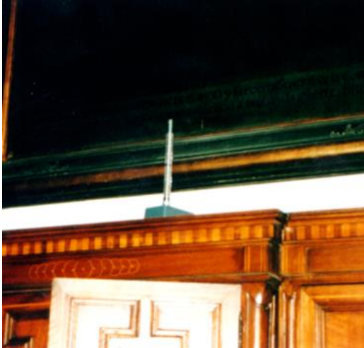
Figura 4.15. Sensor Tª y HR en Sacristía. Basílica de la Virgen.
