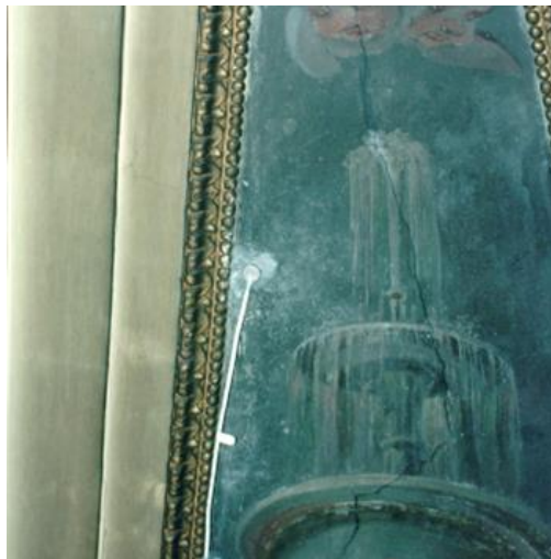
Figura 4.10. Sensor T^a superficial sobre fresco del Camarín. Basílica de la Virgen.
