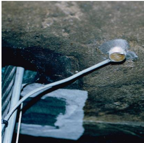
Figura 4.17. Detalle pegado sobre fresco de Palomino de sensores de temperatura Pt100.
