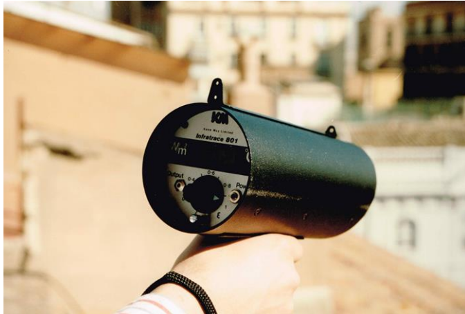
Figura 1.8. Termómetro de infrarrojos y tabla de emisividad de diferentes materiales.
