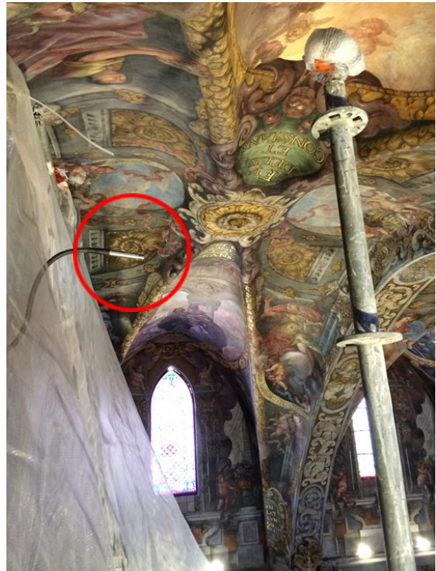
Figura 5.30. Sensor STHB-5 en campo. Zona central de la Bóveda. TH4.
