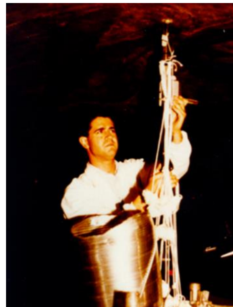
Figura 4.18. Detalles de montaje de sensores en cubierta de tejas y en cúpula principal.
