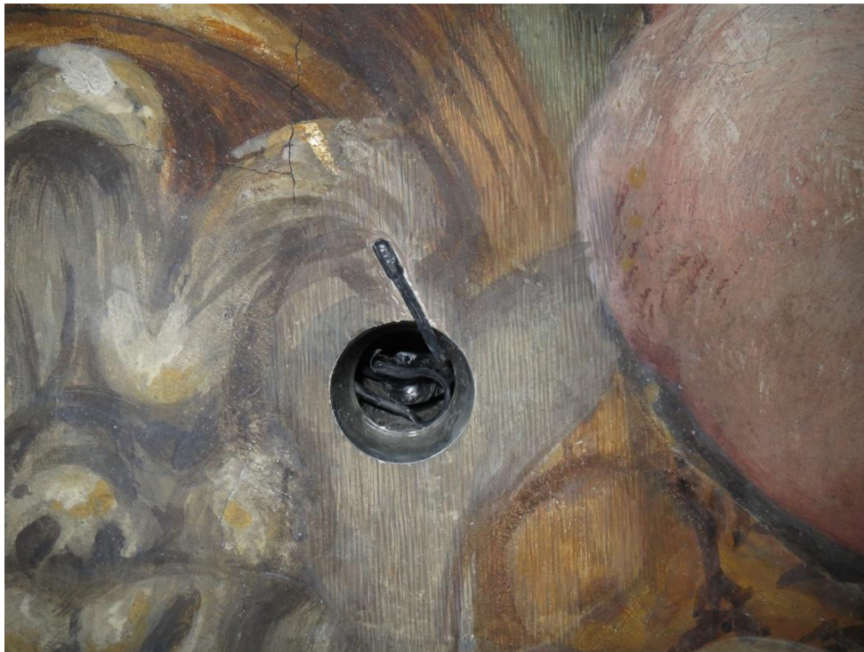
Figura 5.37. Situación de sensor de T a superficial sobre fresco. T5.
