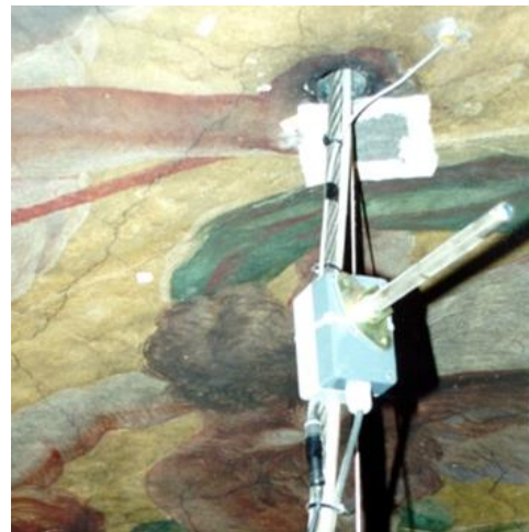
Figura 4.14. Sensor T^a y HR en cúpula. Basílica de la Virgen.
