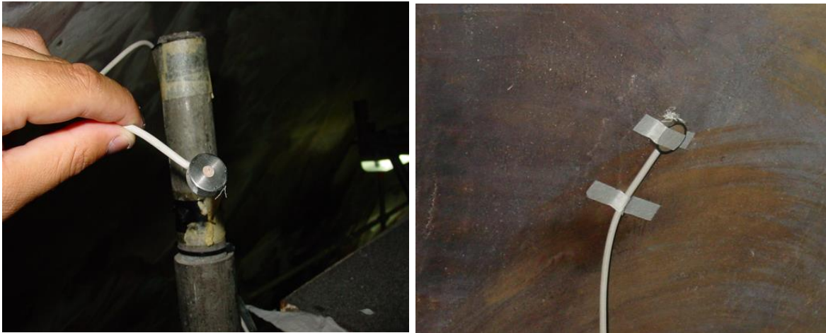
Figura 4.12. Sensor T^a superficial antes y después de pegado sobre el fresco de A. Palomino Basílica de la Virgen.
