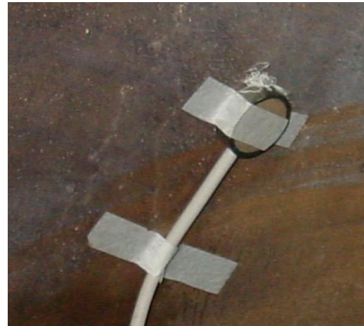
Figura 4.17. Detalle pegado sobre fresco de Palomino de sensores de temperatura Pt100.
