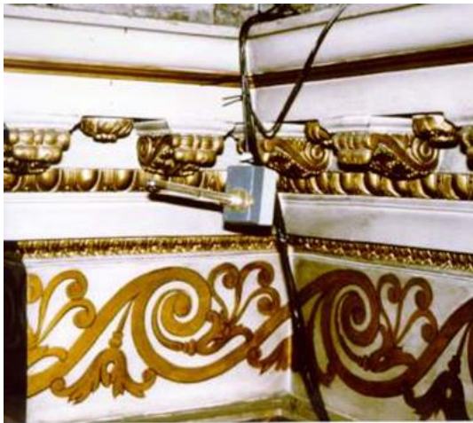
Figura 4.13. Sensor T^a y HR en C. Comunión. Basílica de la Virgen.
