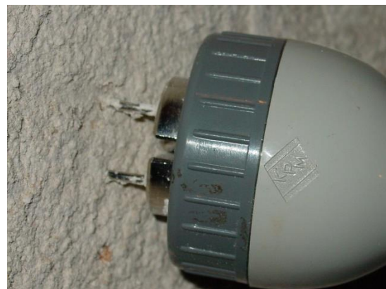
Figura 4.70. Elemento sensor por penetración en superficie.
