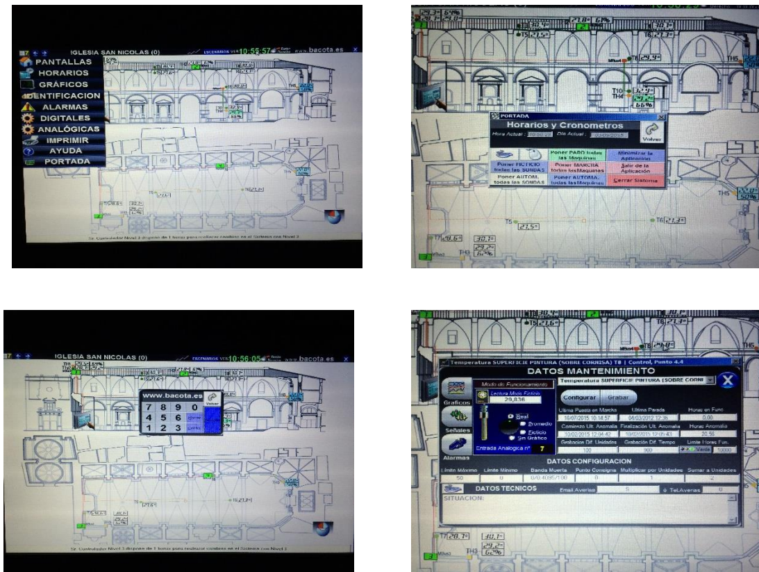
Figura 5.49. Varias pantallas con menús desplegables del sistema centralizado.
