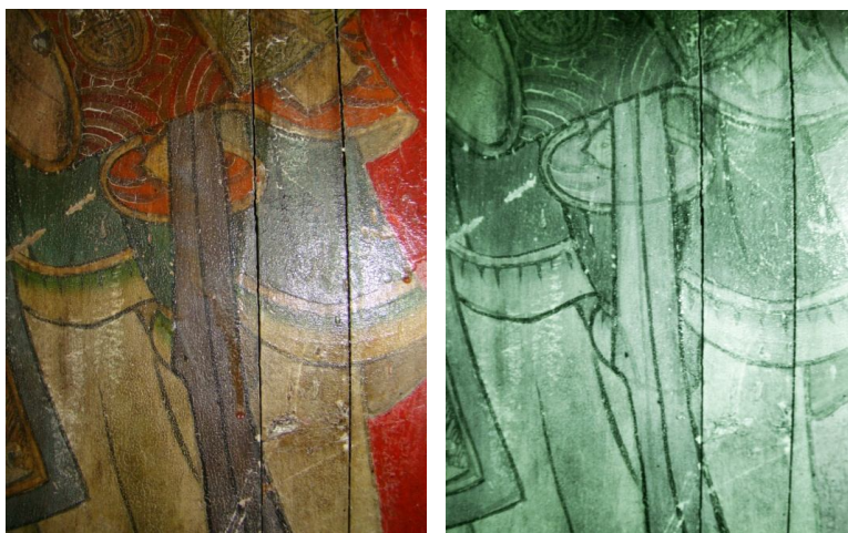
Figura 185. Imagen con luz visible (izquierda) y obtenida mediante fotografía IR (derecha).
