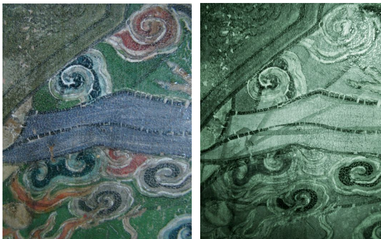
Figura 184. Imagen con luz visible (izquierda) y obtenida mediante fotografía IR (derecha).
