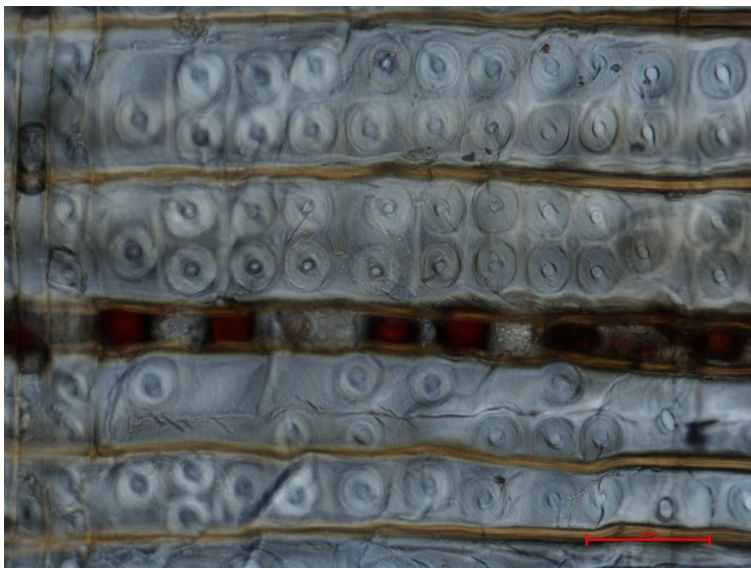
Figura 172. Sección radial de la muestra obtenida con luz visible, 50x.
