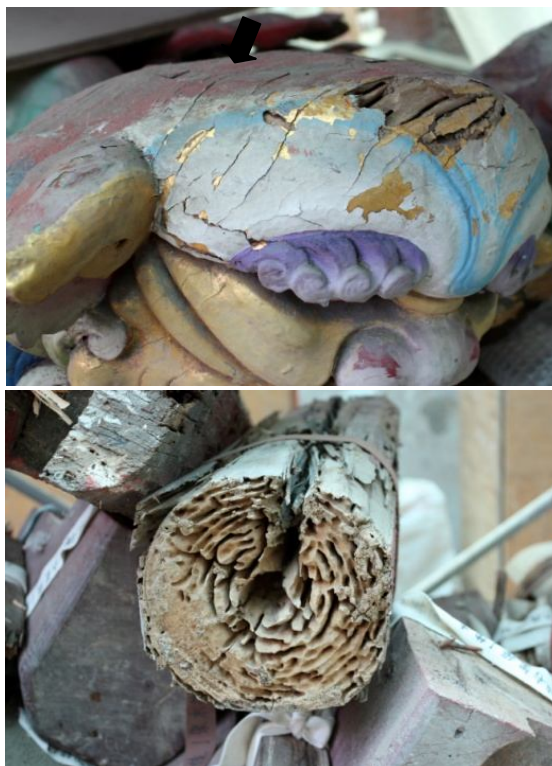
Figura 233. Ataque de insectos xilófagos en estructuras de madera.
