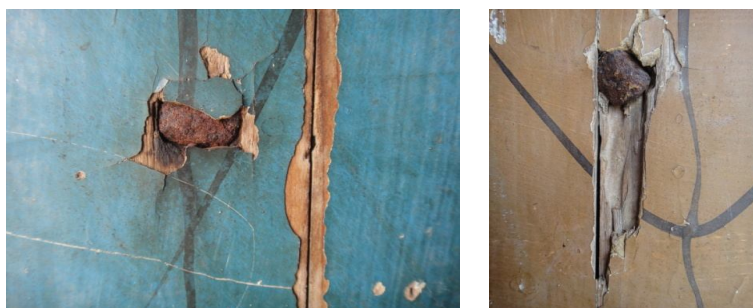
Figura 97. Clavos oxidados que han causado daños en la película pictórica.
