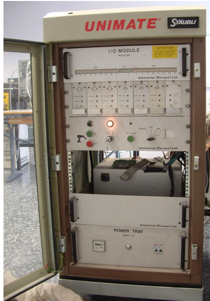
Figura 5-2 Imagen de la Unidad de Control del PUMA 560
