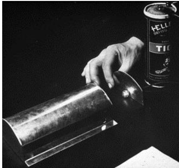
12. Sistema luminoso de comprobación. La batería alimenta una luz que se introduce en la bóveda metálica.
