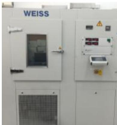
Figura III-23. Equipo para la realización del ensayo de resistencia térmica.
