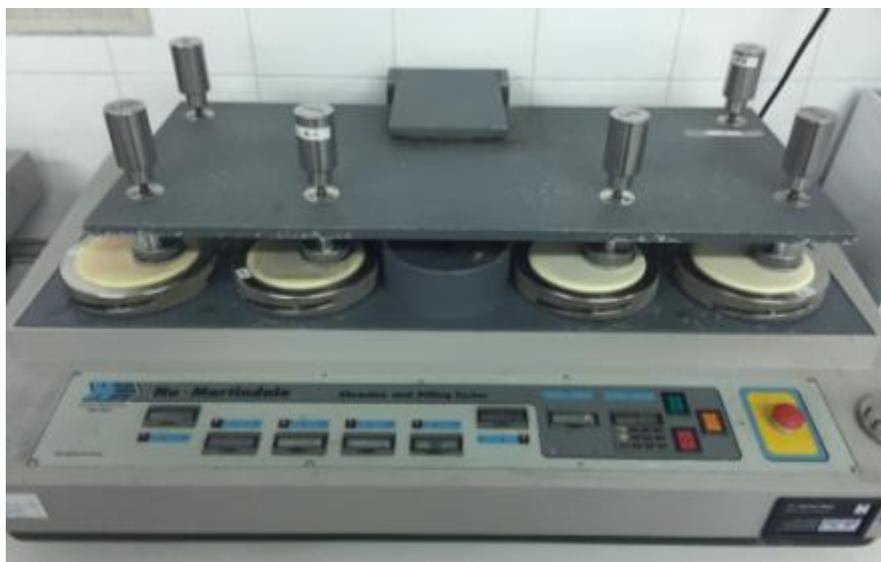
Figura III-17. Equipo para la realización del ensayo de abrasión y pilling.
