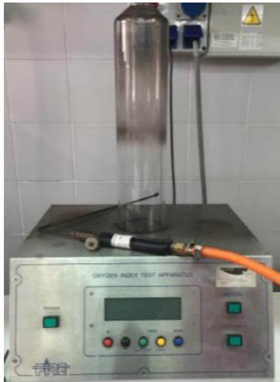
Figura III-21. Equipo para el ensayo del índice límite de oxígeno.
