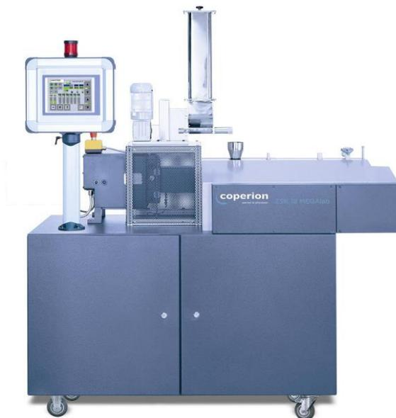
Figura III-3 Vista general de la extrusora de doble tornillo co-rotante
