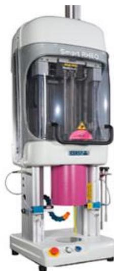
Figura III-20. Vista del reómetro capilar CEAST
