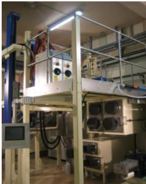
Figura III-4 Planta piloto de hilatura por fusión
