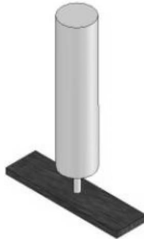
Figura III-18 Esquema del penetrador empleado en la determinación de la temperatura de reblandecimiento Vicat (VST)
