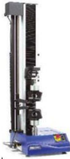
Figura III-19 Dinamómetro INSTRON mod 3343
