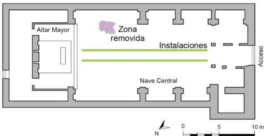
Figura 5.30. Localización en planta de las estructuras detectadas a partir del análisis de los radargramas obtenidos mediante georradar.
