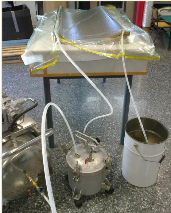
**Figura 7.12: Montaje para la fabricación por Infusión del prototipo de la pieza**
