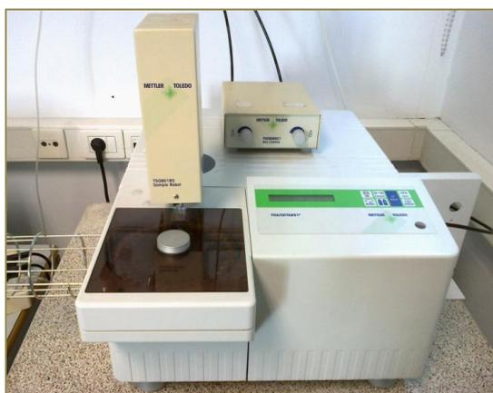
**Figura 3.7: Equipo para análisis termogravimétrico - TGA**
