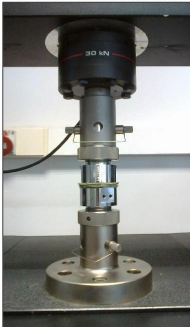
**Figura 4.18:** Ensayo de compresión para la compactación del tejido de lino
