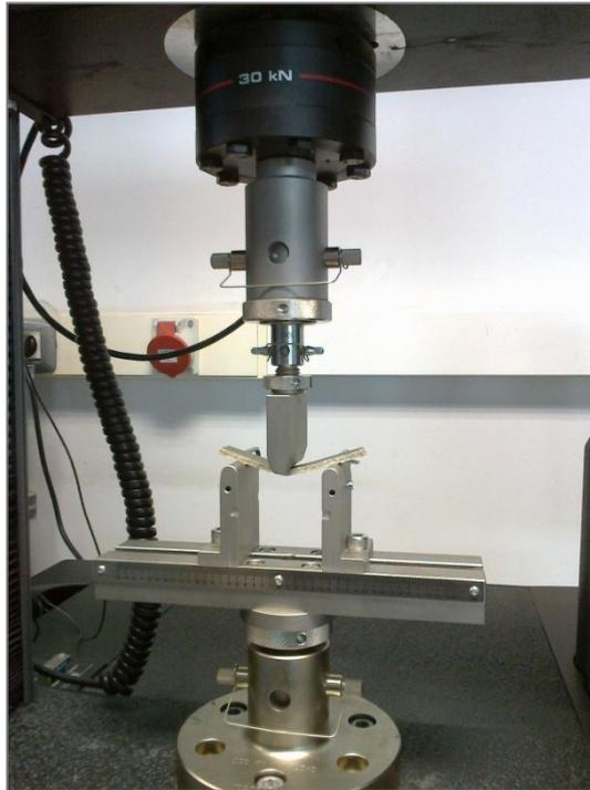
**Figura 6.6: Ensayo de flexión en tres puntos del lino-bioepoxi green composite**
