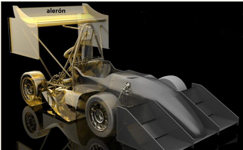
**Figura 7.1: Imagen del diseño del vehículo FS con la pieza del alerón a simular**
