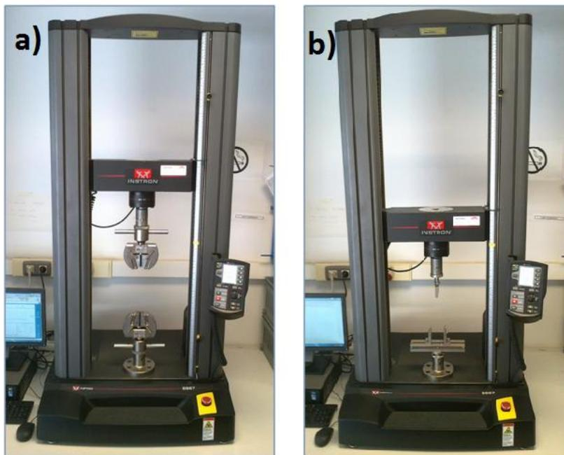
**Figura 3.9: Máquina universal de ensayos con útiles a) ensayo de tracción b) ensayo de flexión en tres puntos**
