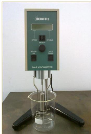
***Figura 3.5: Viscosímetro rotacional para la medida de la viscosidad de la resina***
