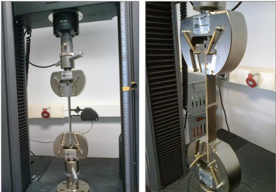
**Figura 6.2: Ensayo de tracción del lino-bioepoxi green composite: izquierda) probeta con extensiómetro, derecha) fin del ensayo por rotura de la probeta**
