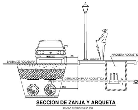
Ilustración 4.2-4. Red de dos tubos y acometida a edificio.
