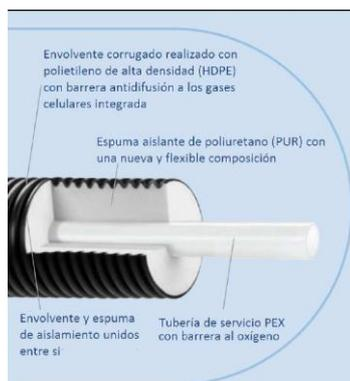
Ilustración 4.3-4. Tubería flexible plástica con barrera al oxígeno. Fuente Efiterm.
