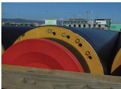
*Ilustración 4.3-9. Cables de detección de fugas embebidos en el aislamiento. Fuente ADHAC.*
