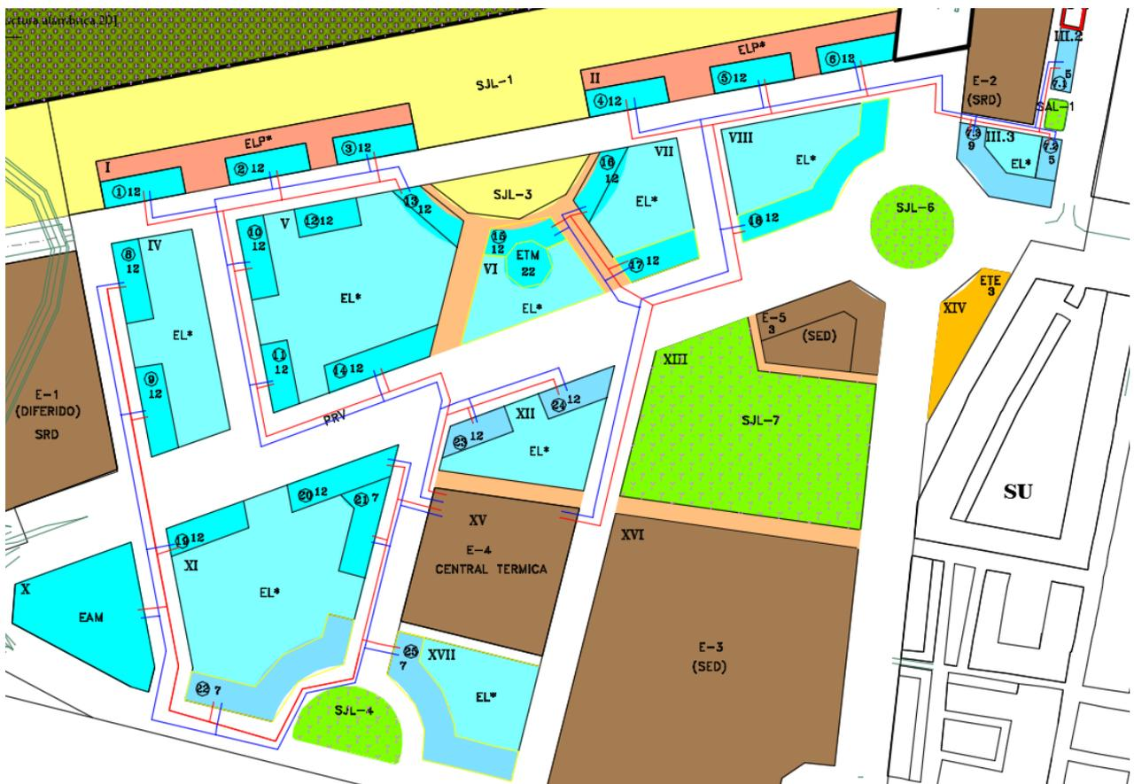
Ilustración 7.6-6: Trazado red de distribución DHC
