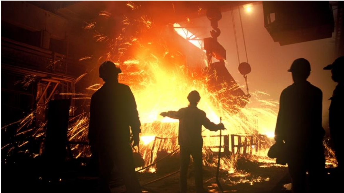
Vertido de la colada de acero fundido sobre cuchara en una acería. 176
