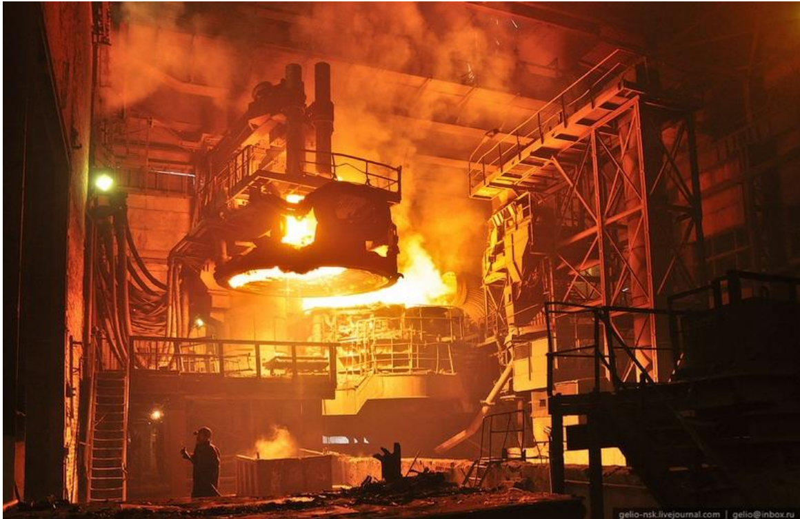
Proceso de fundición en una acería con la bóveda del horno de arco abierta. 178
