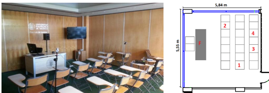
Figura 8.9. Planta, dimensiones, puntos de medida e imágenes de la sala 5
