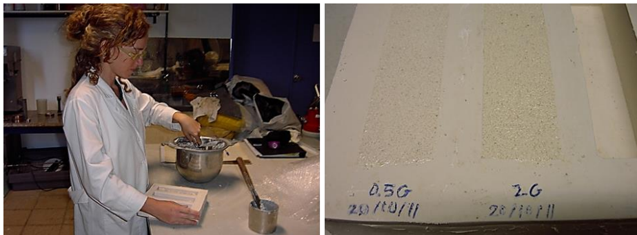
Figura 116. De izquierda a derecha, fotografías que muestran el proceso de enmoldado de las probetas prismáticas
