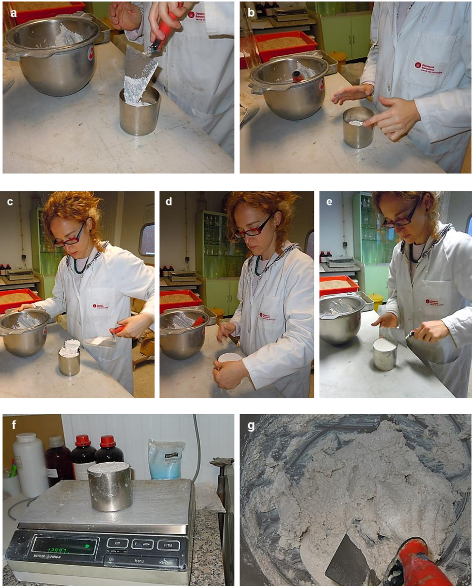
Figura 124. Determinación de la densidad aparente del mortero fresco, de izquierda a derecha y de arriba abajo, fotografías del procedimiento operativo del ensayo de la determinación de la densidad aparente del mortero fresco
