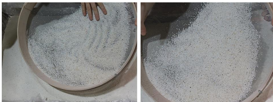
Figura 112. Tamizado (tamiz de apertura de malla 1 mm) manual del árido de arena de mármol de Macael, para conseguir la curva granulométrica propuesta
