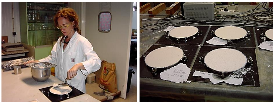
Figura 118. De izquierda a derecha, fotografías que muestran el proceso de enmoldado de las probetas cilíndricas
