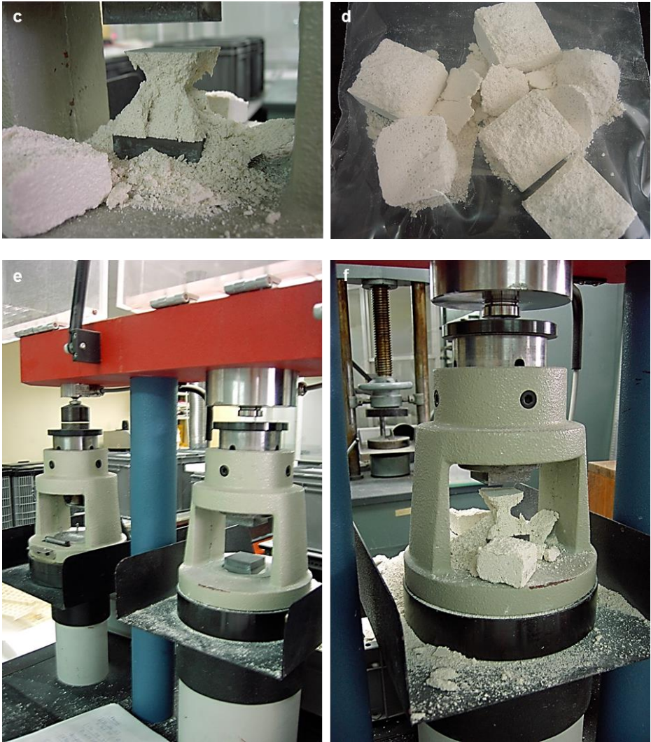
Figura 136. Determinación de la resistencia a la flexión y a la compresión, de izquierda a derecha y de arriba abajo: (a). aplicación de la carga sobre una probeta prismática, para determinar la resistencia a la flexión; (b). aspecto del corte de ruptura de la probeta prismática; (c). aplicación de la carga sobre un semiprisma, para determinar la resistencia a la compresión; (e). vista de la máquina de ensayo de resistencia normalizada (AUTOTEST/CIB, Ibertest) con los dos brazos de carga, de izquierda a derecha de la fotografía, el de flexión y el de compresión, respectivamente; (f). vista general del resultado de una aplicación de la carga sobre un semiprisma, para determinar la resistencia a la compresión.
