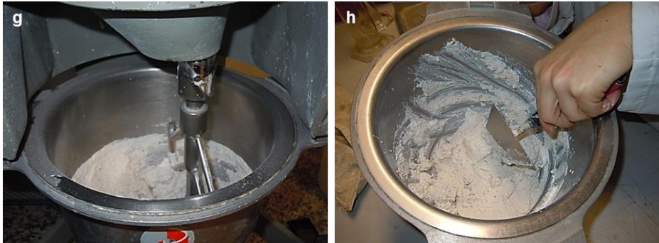
Figura 115. De izquierda a derecha y de arriba abajo: (a). amasado automático de la pasta de cal; (b). pesada de la cal en pasta; (c). pesada del aditivo en polvo con la proporción correspondiente; (d). mezcla de los componentes con una amasadora automática; (e). pesada del árido; (f). incorporación del árido; (g). amasado automático; (h). amasado manual.
