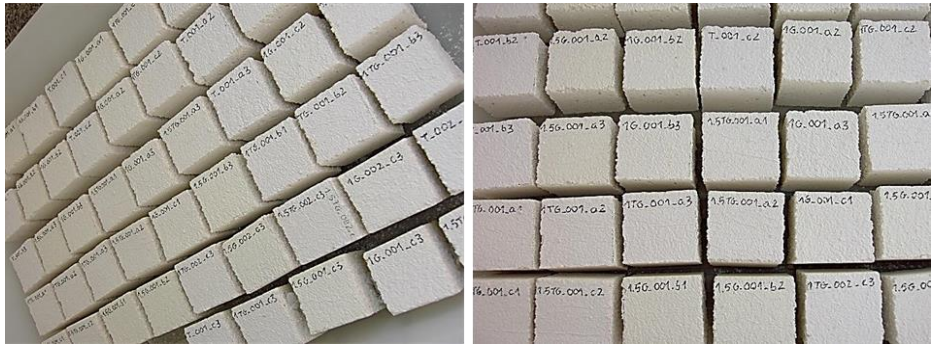
Figura 122. Probetas cúbicas una vez cortadas y conservadas en la habitación climatizada ( 20\pm 5^{\circ}\text{C} y 60\pm 5\% ) hasta el momento del ensayo
