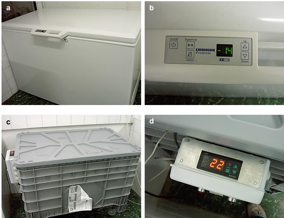
Figura 139. Infraestructura necesaria para llevar a cabo el ensayo de la determinación de la resistencia al hielo-deshielo, de izquierda a derecha y de arriba abajo: (a). y (b). congelador donde se lleva a cabo el período de hielo del ensayo ( T^a = -15 \pm 2 \text{ } ^\circ\text{C} ); (c). y (d). contenedor normalizado donde se lleva a cabo el período de deshielo del ensayo ( T^a = 20 \pm 2 \text{ } ^\circ\text{C} ).
