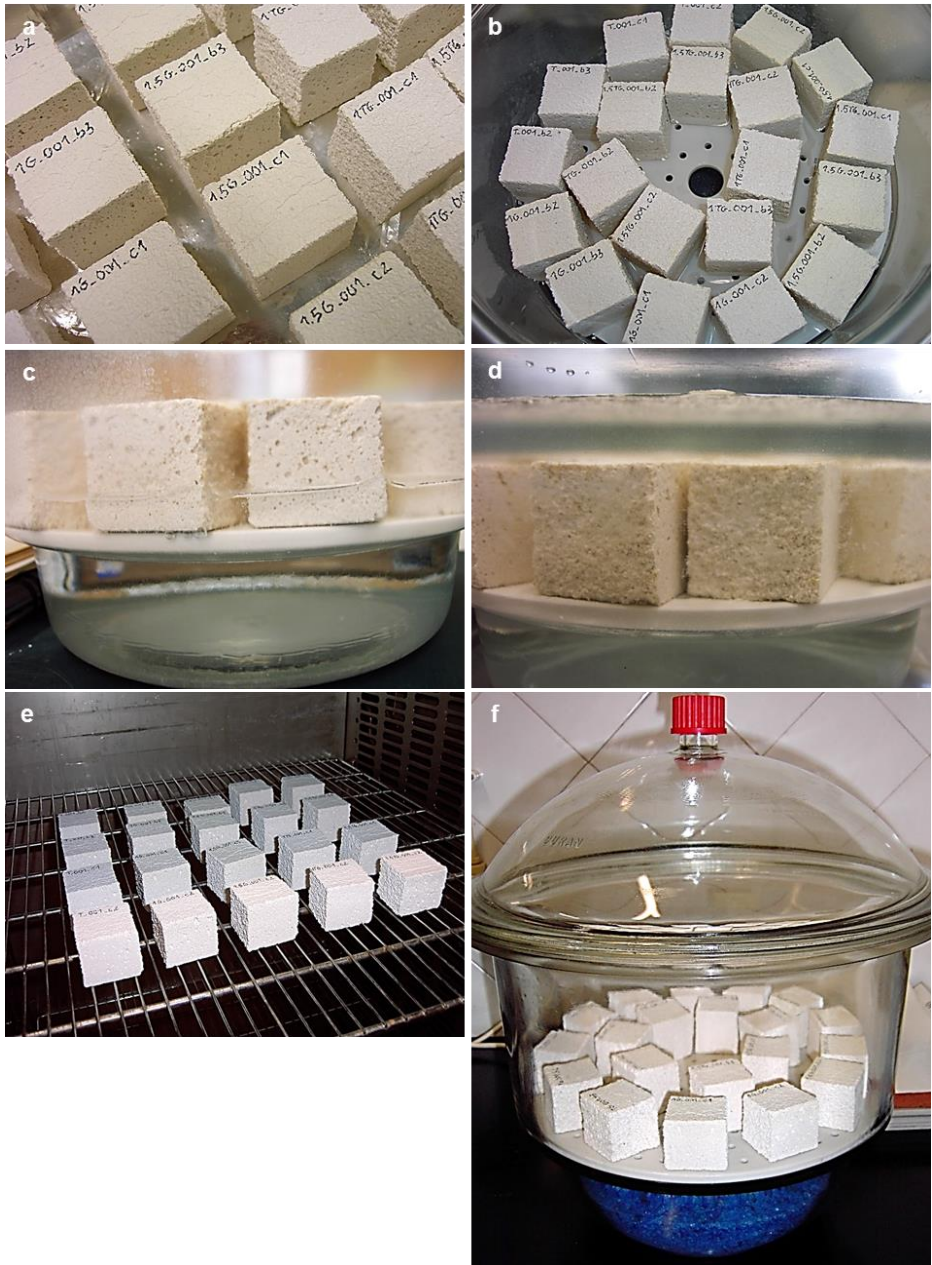
Figura 131. Determinación del coeficiente de saturación, de izquierda a derecha y de arriba abajo: (a). selección de las probetas para el ensayo; (b). inmersión, hasta la mitad, de las probetas cúbicas con agua desmineralizada; (c). detalle de la imagen b; (d). incorporación de agua desmineralizada sobrepasando 2 cm las probetas; (e). introducción de las probetas en la estufa a 60 °C hasta peso constante; (f). conservación de las probetas en un desecador hasta el momento del ensayo siguiente
