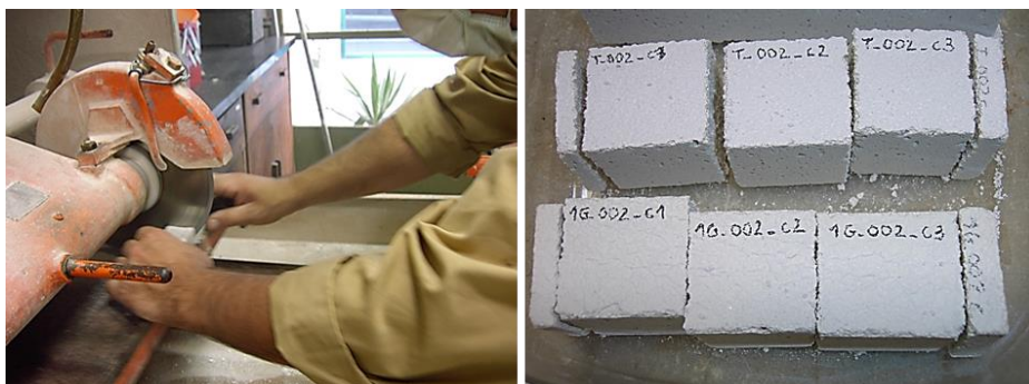
Figura 117. De izquierda a derecha, fotografías que ilustran el proceso de cortar las probetas prismáticas para obtener las probetas cúbicas
