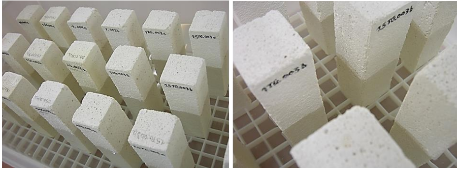
Figura 138. Imágenes que ilustran el procedimiento de sumergir las probetas prismáticas con agua desmineralizada, para saturarlas.
