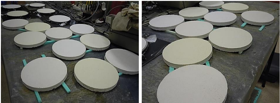
Figura 121. Probetas cilíndricas desmoldadas y conservadas en la habitación climatizada ( 20\pm 5^{\circ}\text{C} y 60\pm 5\% ) hasta el momento del ensayo
