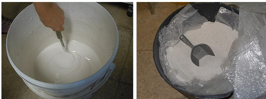
Figura 114. De izquierda a derecha, cal en pasta de St. Astier (clase CL 90-S en pasta) y árido de arena de mármol Macael tamizado (granulometría: 0,063 mm < \Phi < 1.00 mm)
