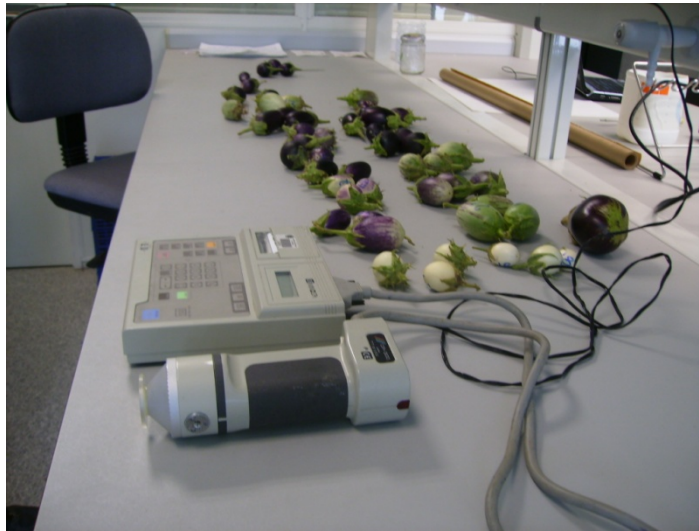
Figura 24. Colorímetro que se utiliza para la medición del pardeamiento de la carne del fruto.
