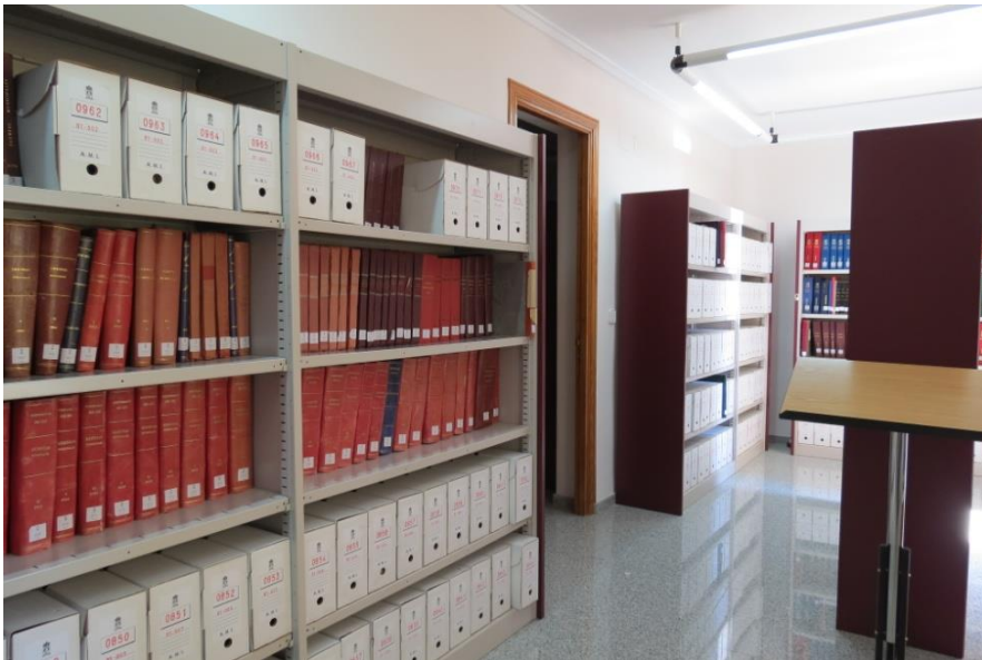
Figura III.40. Depósito con estantería fija. No es posible equipamiento con estantería móvil por la limitación de la sobrecarga de uso.
