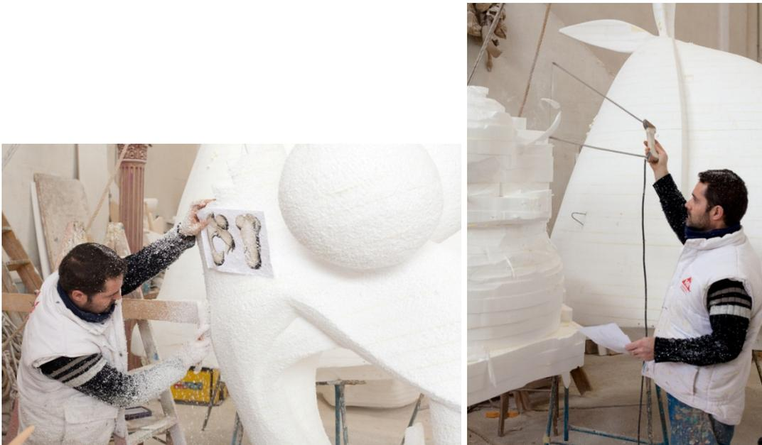
**Imagen 69.** Izquierda: Artista en el taller de Pepe Latorre, lijando con el renderizado 3D de muestra delante. Derecha: Artista con una termocortadora para modelar el corcho blanco.
