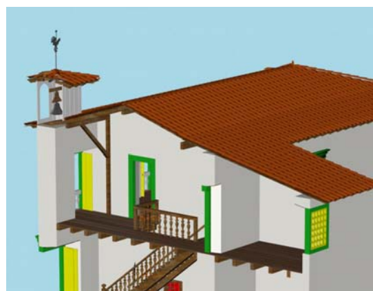
Fig. 122 - Enmaderamiento y jabalcón de la cubierta del Ayuntamiento y Cárcel de la Ciudad de Goiás, Goiás. (Diseño de la autora).
