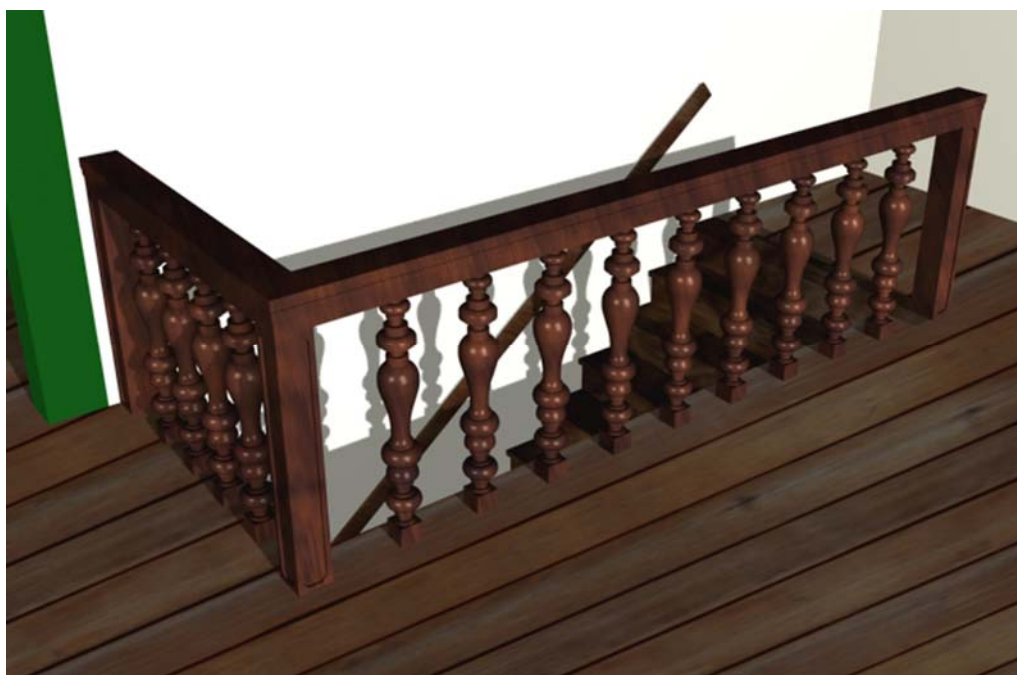
Fig. 116 - Barandilla del piso superior del Ayuntamiento y Cárcel de la Ciudad de Goiás, Goiás. (Diseño de la autora).
