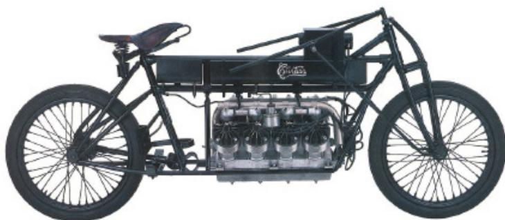
Em 1907 Glenn Curtiss conduziu uma moto com motor de dirigível V-8 arrefecido a ar a uma velocidade de 219 km/h. O motor desenvolvia 40 cv e pesava 125 kg. Este recorde tornou-o no homem mais rápido do mundo em moto ou automóvel e apenas foi batido onze anos depois por um automóvel. Apenas em 1930 outra moto conseguiu superar esse feito. De acordo com um artigo da revista *Scientific American* da época, a moto teve uma ruptura no quadro, o que deformou o quadro<sup>22</sup>.
