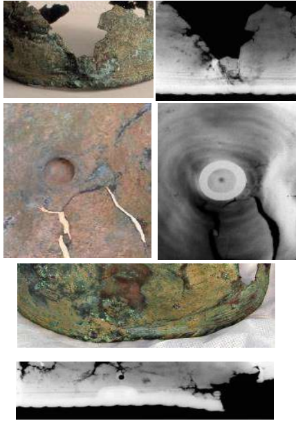
Figura 6.2. Imágenes fotográficas (izquierda) y radiográficas (derecha) obtenidas mediante radiografía directa de rayos X de diferentes partes del Casco.
