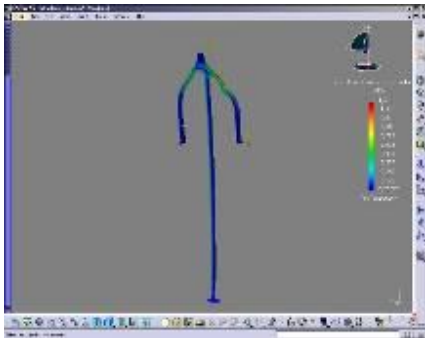
Figura 7.13. Diagrama de esfuerzos de flexión del Casco sobre el soporte.
