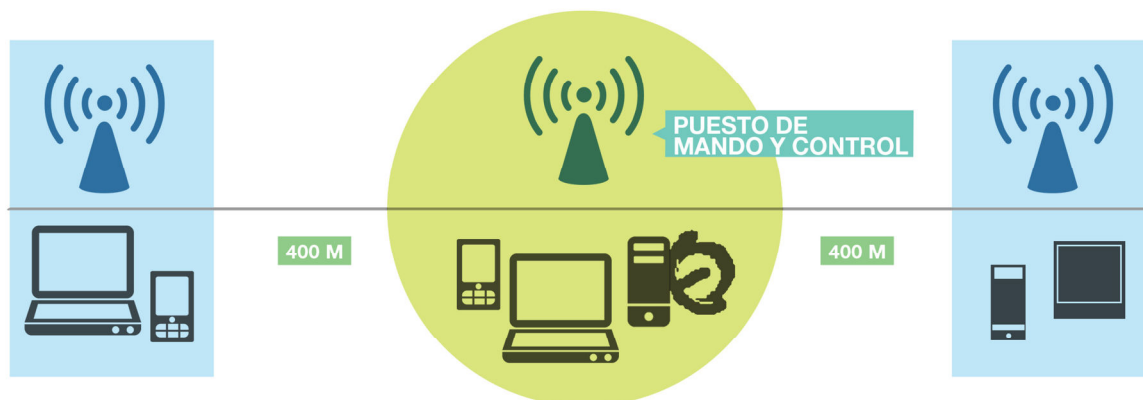
Figura 111. Topología de red utilizada durante las pruebas
