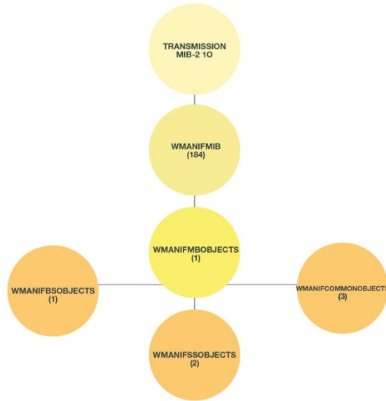
Figura 26. Esquema de la WMAN IF MIB definida en IEEE 802.16f
