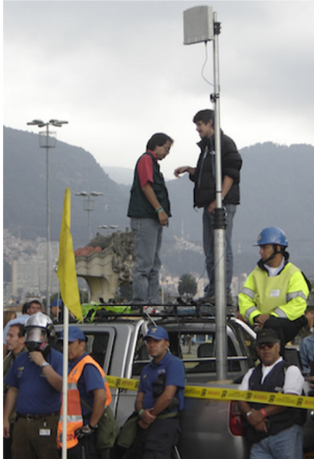
Figura 107. Vehículo de comunicaciones WiMAX, con CPE Airspan para enlace hacia el puesto de mando retrasado
