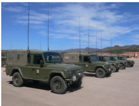
Figura 90. Vehículos Aníbal equipados con antenas VHF PR4gv3
