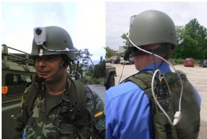
Figura 76. Sistema completo con cámara y radio Spearnet
