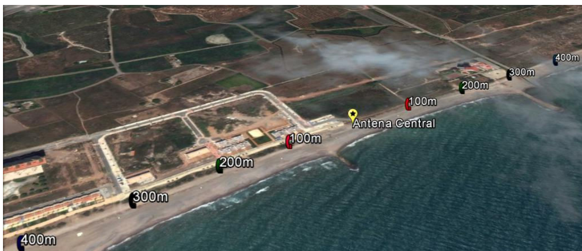
Figura 112. Ubicación inicial y recorrido realizado con las radios Mesh Breadcumb.
