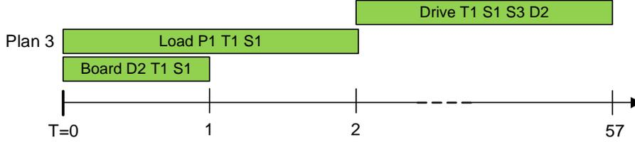
Figura 5.5: Resultado del cálculo del instante de comienzo más temprano para el ejemplo de la Figura 4.7
