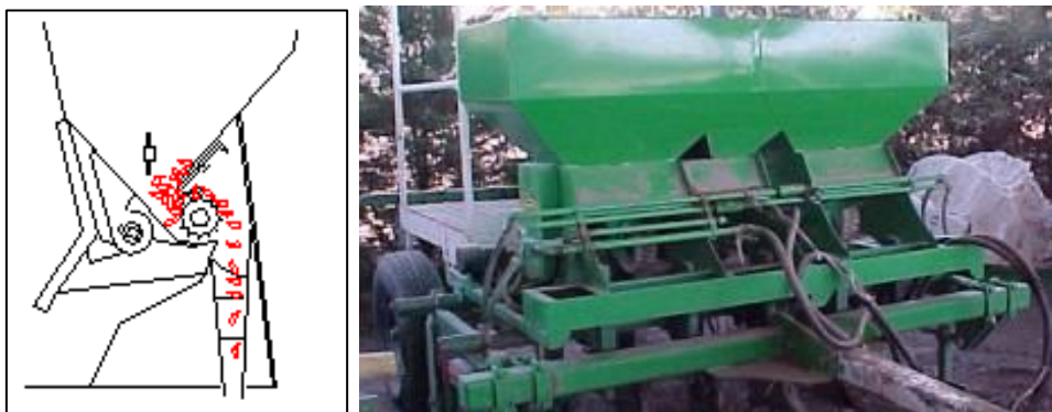
fig. 27. Sembradora automática con distribuidor por rueda dentada.
