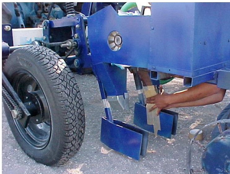
fig. 111 Colocación de cinta y calibración de los abresurcos.
