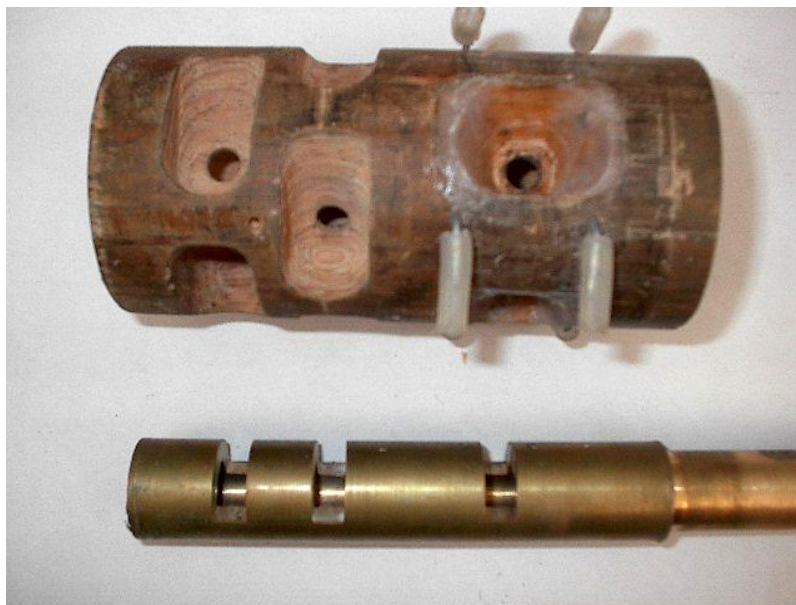
fig. 66 Unidad experimental del rodillo con su eje.
