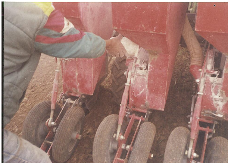
fig. 42 Colocación de talco en los platos para evitar el atasco en los orificios
