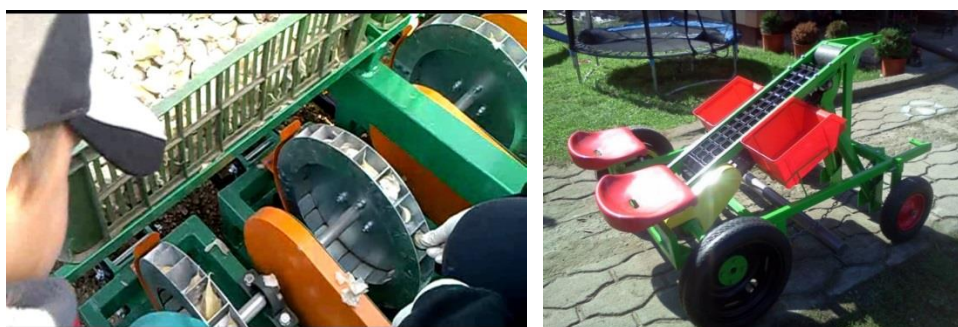
fig. 24. Sembradora semiautomática de cangilones
