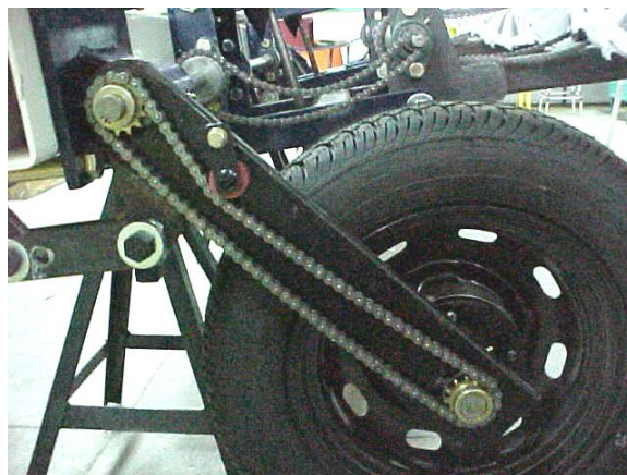
Fig. 106 Rueda copiadora y sistema de transmisión por cadena.
