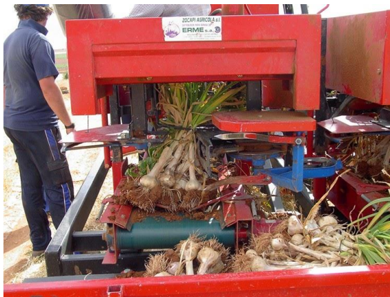
fig. 15 Arrancadora atadora, (“ERME”, 2015).
