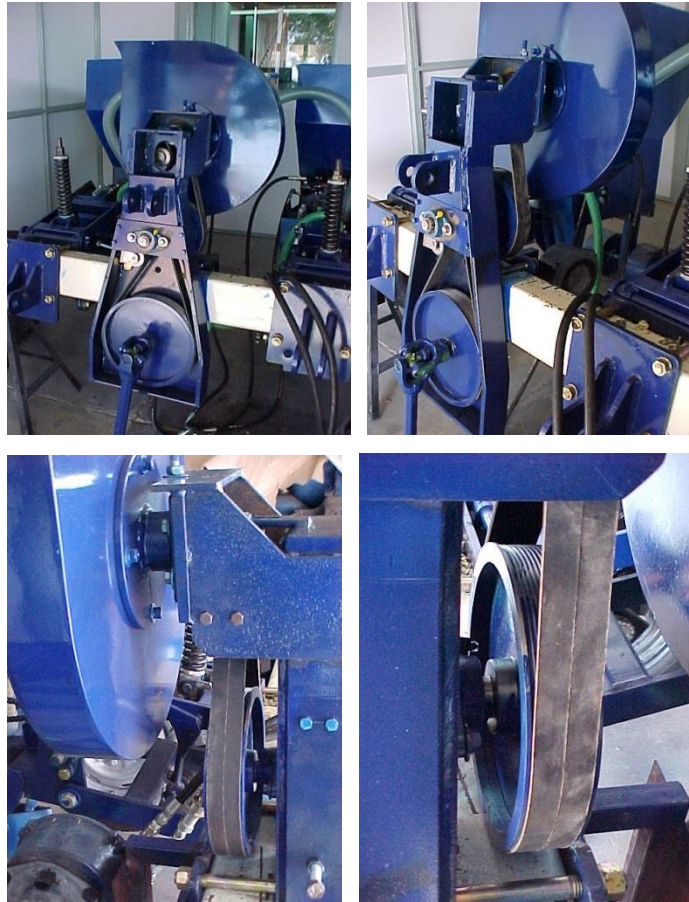
fig. 103 Vistas generales de la transmisión modificada
