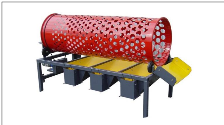
fig. 3. Clasificadora de ajo, “ERME”, 2015.
