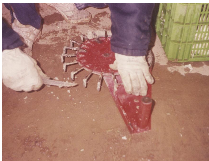
fig. 44 Limpieza del mecanismo de agitación
