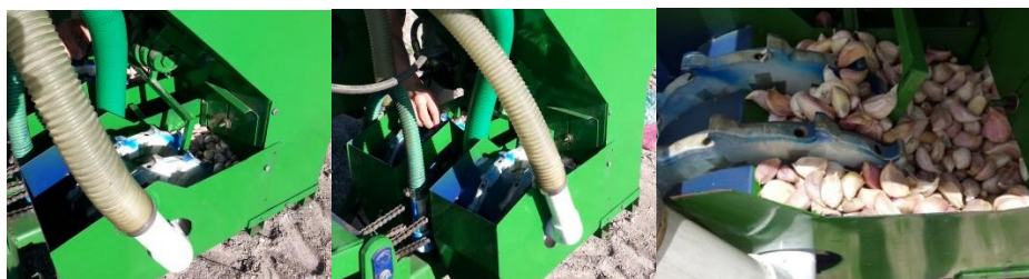
fig. 121 Niveles abertura de compuerta de abastecimiento, 50%, 75% y 100%.
