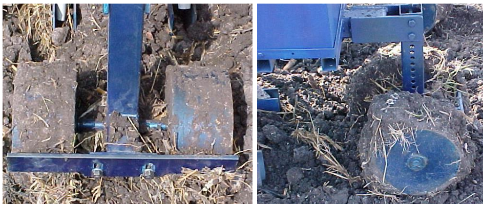
fig. 119 Detalles de atasco de las ruedas tapadoras debido al exceso de humedad
