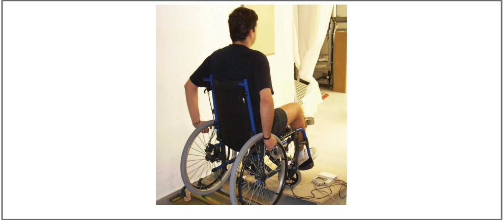
Figura 3.11. Usuari impulsant-se sobre una estructura de corrons durant l'assaig de microclima
