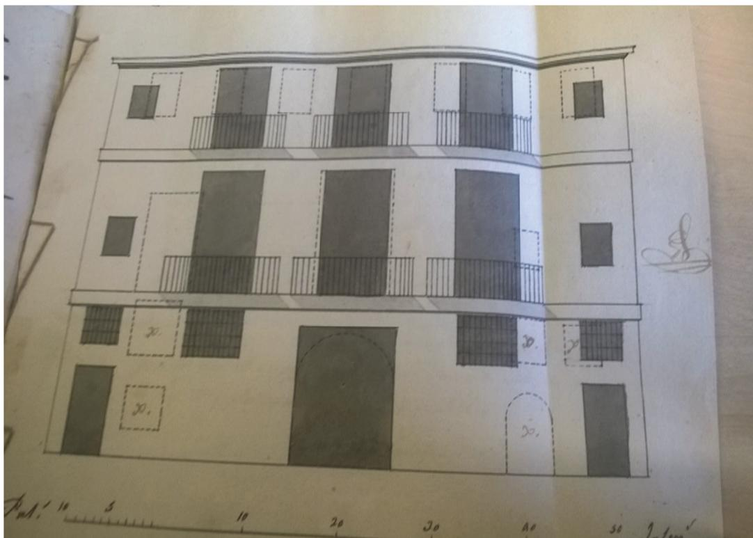
Imagen 195. Alzado de reforma de una vivienda en la calle del Empedrado 12.
