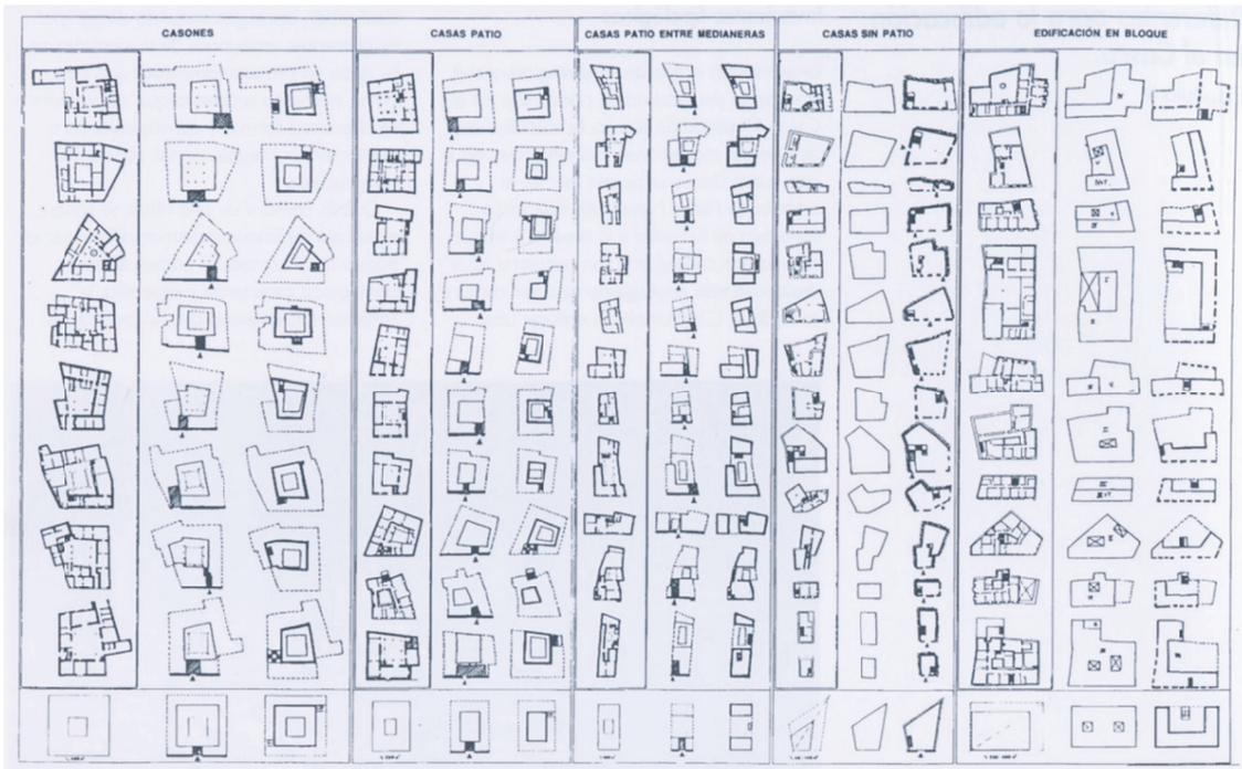
Imagen 17. Plan Especial de Toledo, clasificación tipológica de los edificios.
