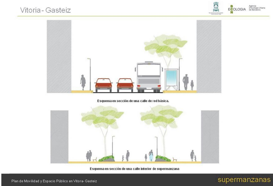
Imagen 9. Vitoria, secciones de calle básica y “supermanzana”.
