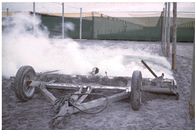
Figura 22. Rastrillo jalado por una maquinilla (NEM/PSTEAM, 2003).
