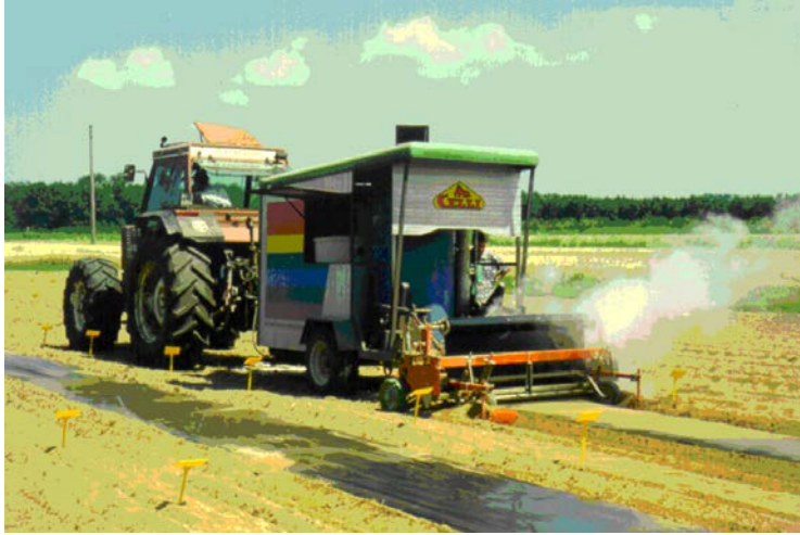
Figura 30. Vista lateral de la máquina para la desinfección del terreno versión remolcada (Peruzzi et al. , 1999).
