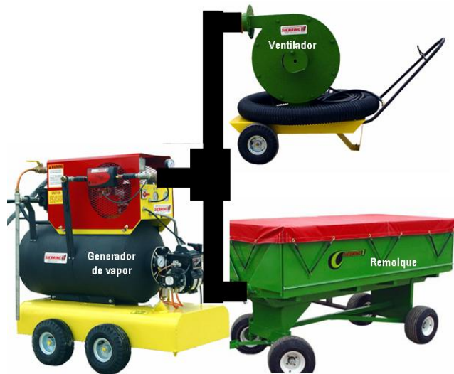
Figura 39. Equipo utilizado para aplicar vapor de agua-aireado dentro de un remolque (Siebring.html, 2003):
