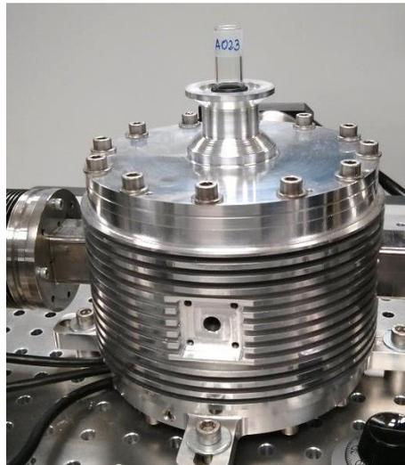
*Figura 2.20: Cavidad monomodo sin mecanismos de sintonización.*
