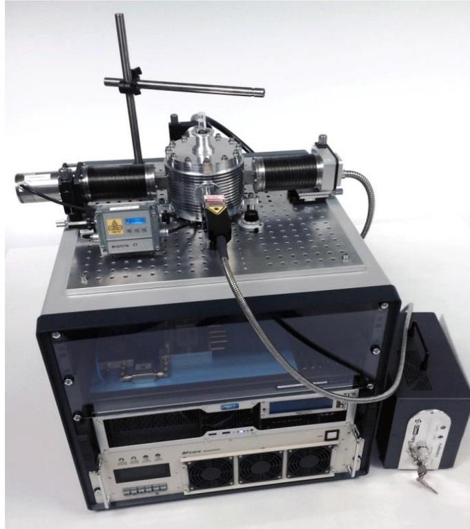
*Figura 5.14. Foto del sistema basado en cavidad monomodo no sintonizable.*
