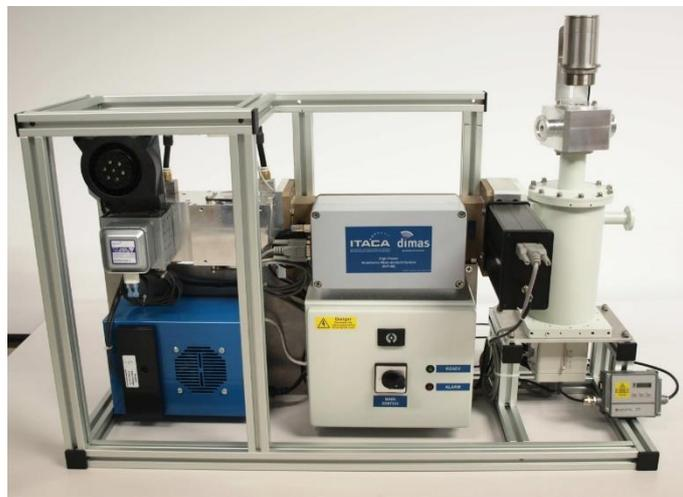
*Figura 5.9: Sistema basado en cavidad sintonizable.*
