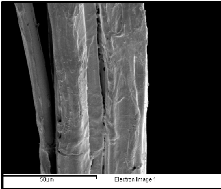
Ilustración 23. Imagen de electrones retrodispersados (SEM) de una fibra de seda del tejido de organza sin envejecer y sin exponer a fuerzas mecánicas, x1000.
