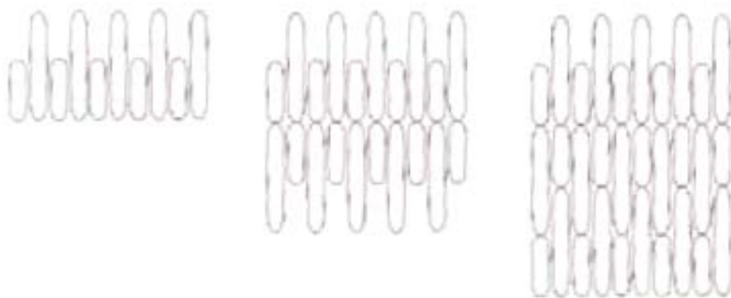
Ilustración 52. Esquema de la puntada de sombreado de una sola capa. Esquema extraído de Bertin-Guest, J. 2003, p61
