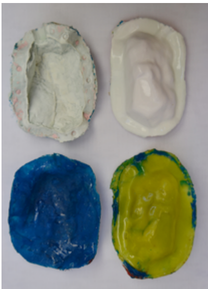
Fig. 37 Molde de caucho de silicon con refuerzo de fibra de vidrio para una roca.
