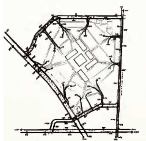
Tráfico de entrada y salida en un día con apertura nocturna entre las 9 p.m. y las 10 p.m. Northland Shopping Center, Detroit. Victor Gruen Associates.
