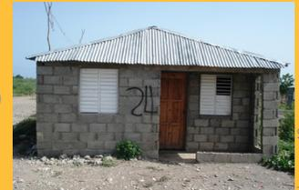
Edificio de un nivel con paredes de mampostería sin reforzar compuesta por bloques prefabricados, cubierta de hojas corrugadas de zinc y suelo de cemento.
