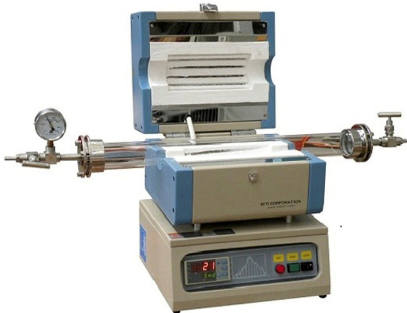
Figura 4.6 Horno Split Horizontal con tubo de Cuarzo Marca MTI OTF-1200 (imagen propia)
