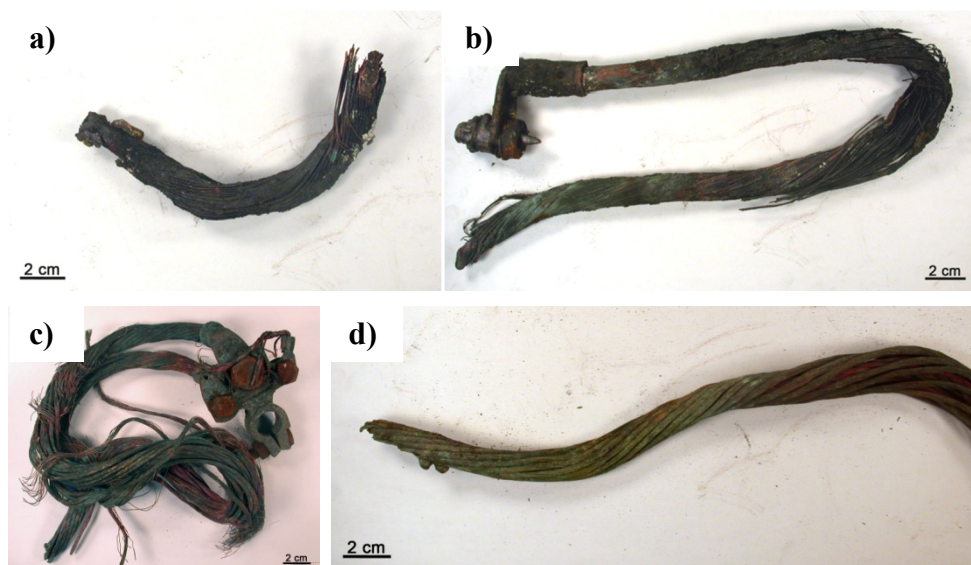
Figura 5.74 Vista general de las muestras sometidas a análisis a) y b) componen la Muestra 1 al tratarse del mismo cable seccionado c) Muestra 2 y d) Muestra 3
