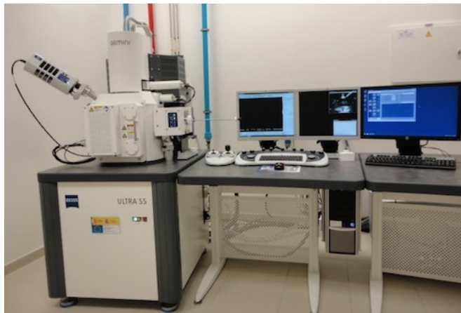
Figura 4.3 Microscopio electrónico de barrido de emisión de campo ( Servicio de microscopía UPV )
