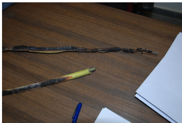
Figura 3.7 Muestra de cableado de cobre procedente del incendio denominado CASO 1 (imagen propia)
