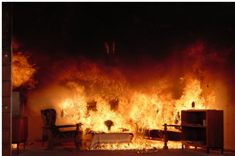
Figura 2.9 Reproducción de un incendio doméstico, en un salón. Instantánea tomada en el momento inicial de desarrollo del flashover , combustión súbita o generalizada (imagen obtenida de http://bomberosalcorcon.blogspot.com.es/2007/10/estudio-de-un-flashover-o-combustin.html )
