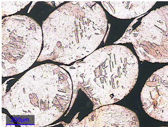
Figura 6.15 Microestructura de hilos procedentes del incendio real denominado CASO 5 (200X), ausencia de cuellos de sinterización
