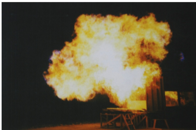
Figura 2.10 Ensayo de incendio confinado en el interior de un contenedor. Instantánea tomada en el momento de ocurrencia de una explosión de humo o backdraft (Babrauskas, 2003, pág. 648)
