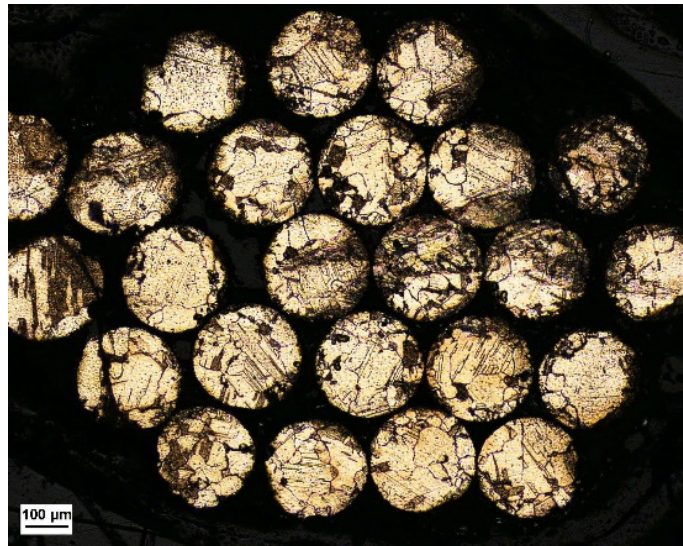
Figura 6.27 Microestructura del corte 1 de la muestra analizada en el CASO 2 (50X)
