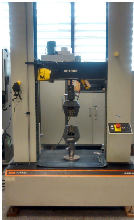
Figura 4.5 Máquina universal de ensayos de 5 kN Instron 4204 con mordazas mecánicas ( Instituto de Tecnología de Materiales UPV )
