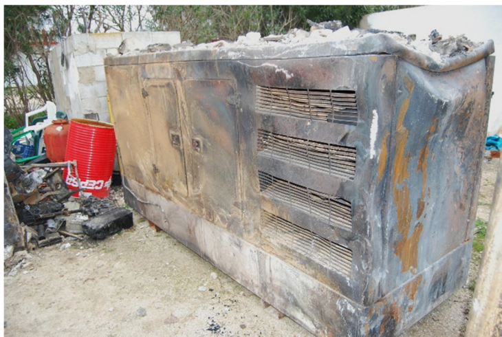
Figura 2.16 Imagen de los efectos de la aplicación directa de las llamas sobre una superficie metálica, se observan claros efectos de reducción con una coloración azulada o grisácea, viéndose afectado su perímetro por oxidación superficial, con tonalidades anaranjadas (imagen propia)
