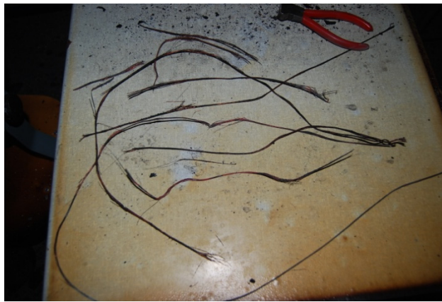
Figura 3.8 Muestra de cableado de cobre procedente del incendio denominado CASO 2 (imagen propia)
