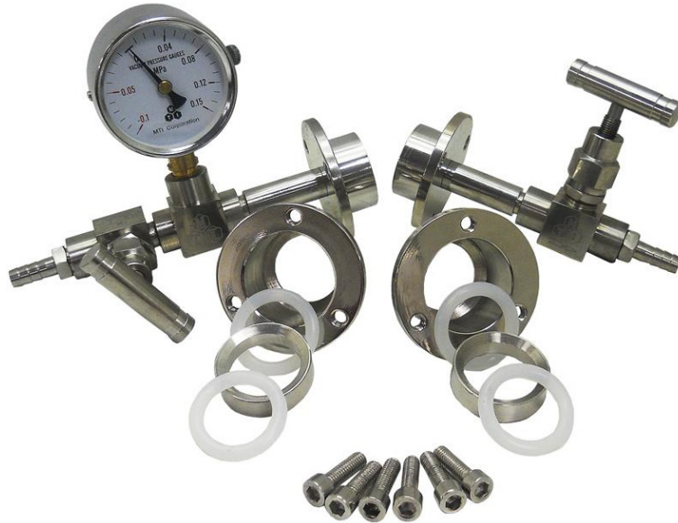
Figura 4.7 Bridas para vacío en el tubo de cuarzo con manómetro y juntas para bajo vacío (imagen propia)
