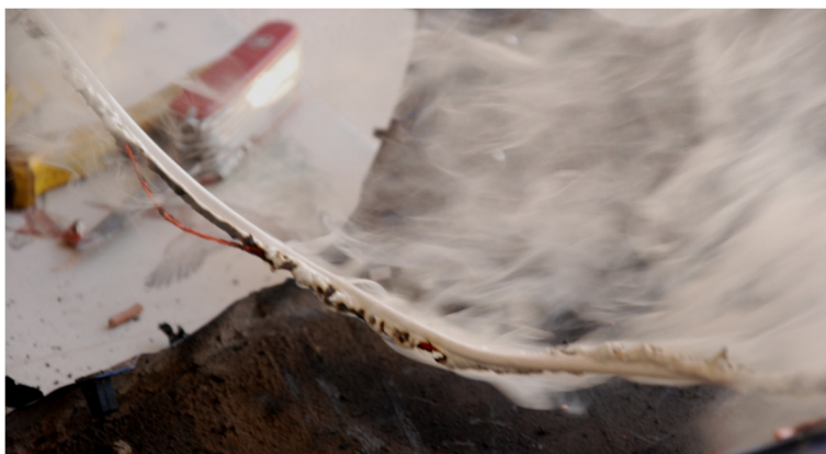
Figura 2.25 Recreación de una sobreintensidad en un cableado eléctrico (imagen propia)
