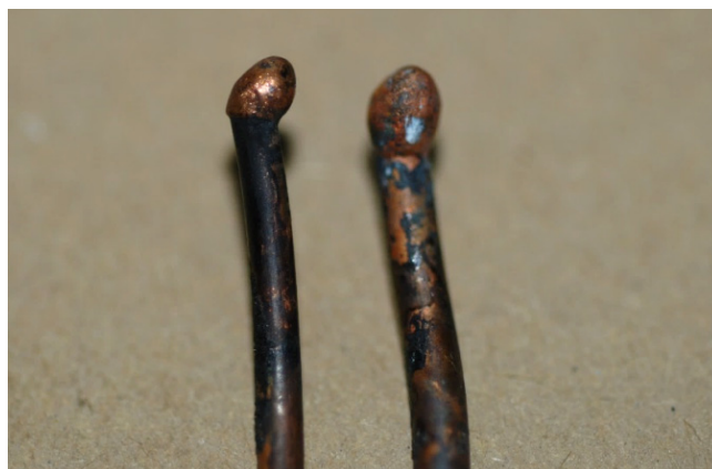
Figura 2.23 Cableado unifilar seccionado con perlado, a consecuencia de un cortocircuito en el cuadro eléctrico de una vivienda que sufrió un incendio (imagen propia)
