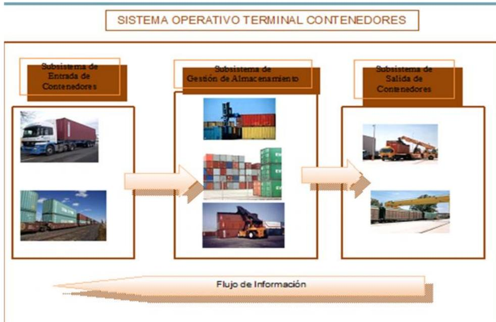
Figura 32. S.O. Terminal Contenedores y Subsistemas.
