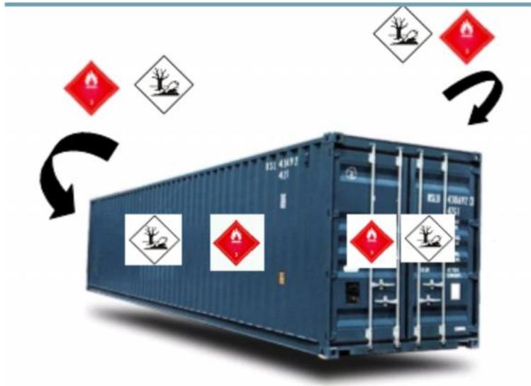
Figura 21. Contenedor de mercancías peligrosas con etiquetas identificadoras que debe llevar e indicando donde deben estar.
