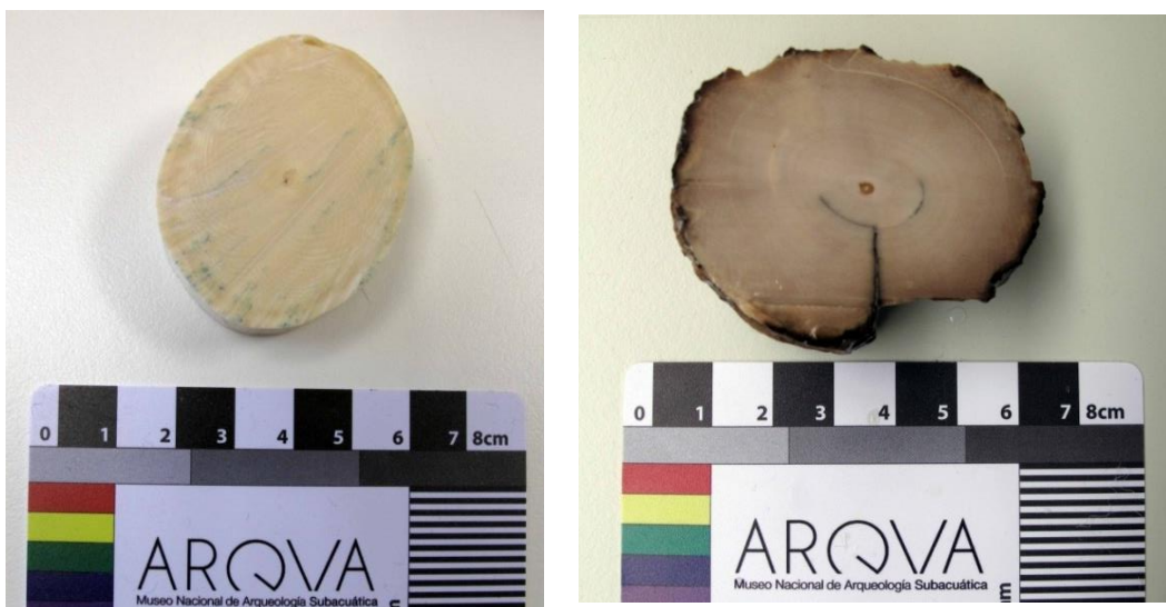
Figura 198. Secciones de marfil moderno no degradado y marfil arqueológico (SJBC_11_2471_6) para caracterización inicial (Imagen tomada por la autora. Archivo fotográfico del MNAS)
