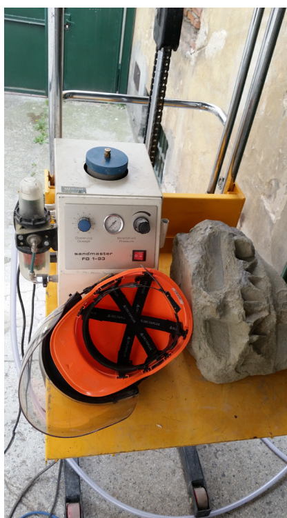
- Fig. 20: Equipamiento y máquina de árido a presión - Fig. 21: Árido proyectado (arena común con un grosor de 0'01 mm.)
