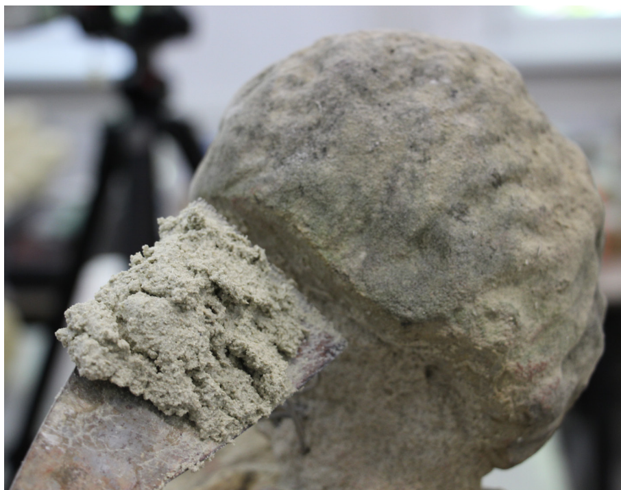
- Fig. 34: Comparación de color entre el mortero realizado y la piedra original
