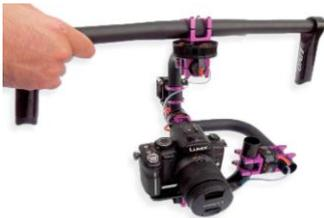
Figura 20. Ejemplo de gimbal modelo MobiPro® con cámara Lumix®.
