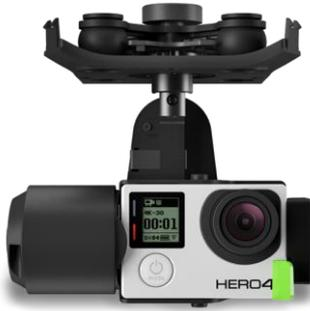
Figura 19. Ejemplo de gimbal modelo 3 Axis Gimbal® con cámara GoPro®.
