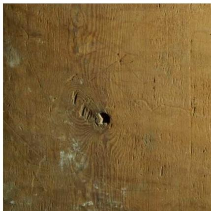
Figura 29. Nudo parcialmente eliminado y marcas sobre el soporte.
