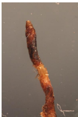
Figura 20: Detalle de la torsión en Z del hilo
