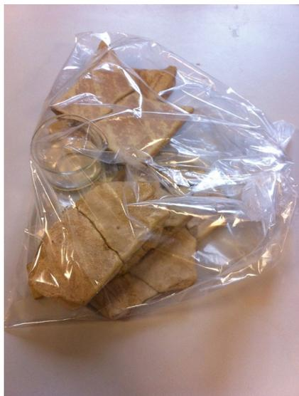
Fig. 31: Ejemplo de cámara de vapor de acetona.
