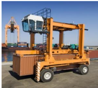
Figura 17 Imagen de un Shuttle Carrier Fuente: FEPORT
