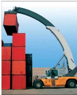
Figura 21 Reach Staker con brazo telescópico curvo. Fuente: (Monfort et al, 2011)
