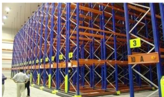
Figura13 Instalaciones para almacenamiento de pallets. Friopuerto (Valencia). Fuente: Fundación Valenciaport.
