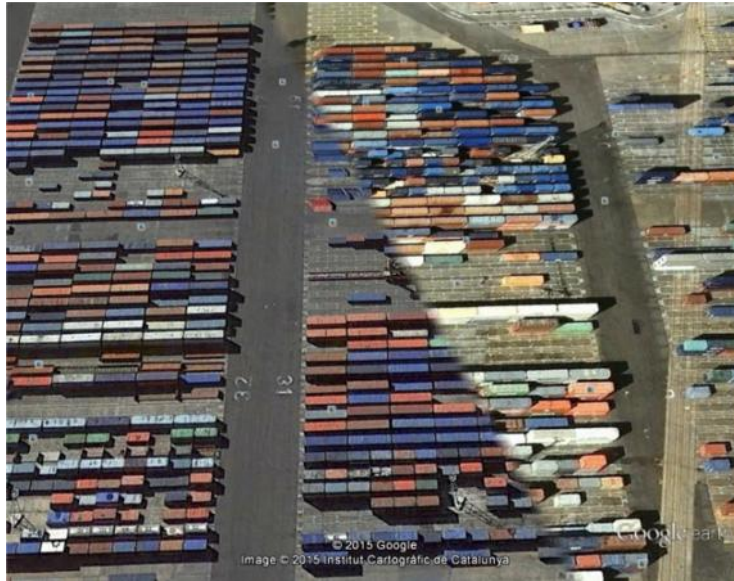
Figura 28 Configuración de layout utilizando straddle carriers Fuente: Google Earth. Terminal de Contenidors de Barcelona, SL (TCB) Muelle Sur
