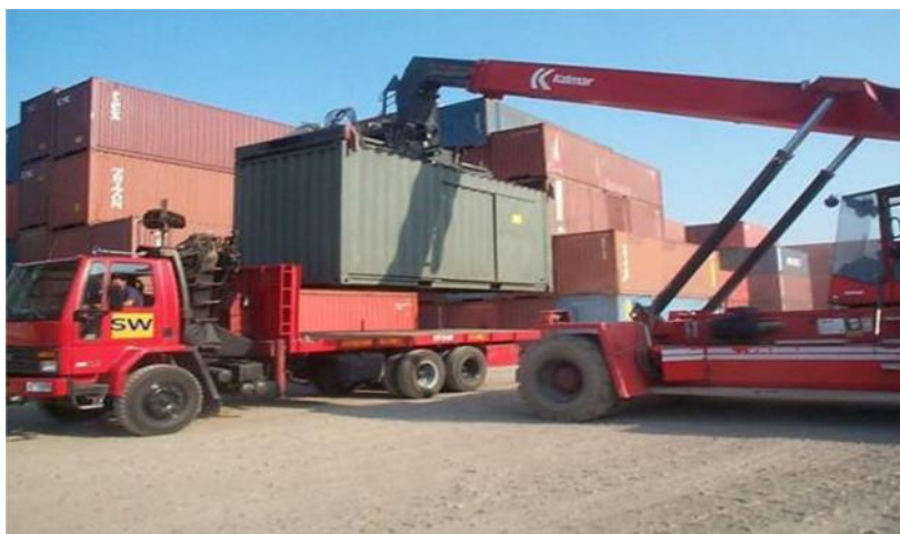
Figura 22 Una ReachStacker posando un contenedor sobre una plataforma Fuente: FEPORTS
