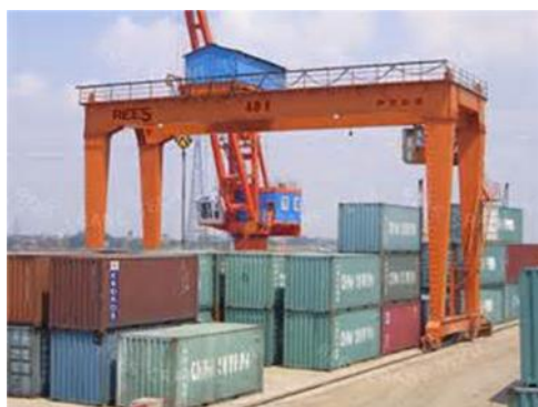
Figura 24 Imagen de una Rail Mounted Gantry Crane (RMG) Fuente: www.reescrane.com
