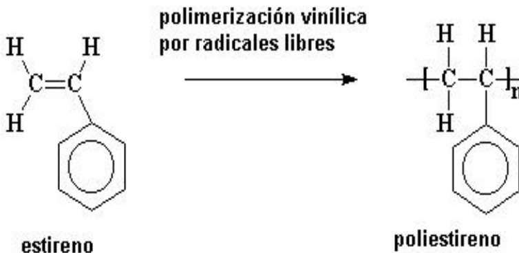
Figura I.7. Proceso de polimerización del PS
