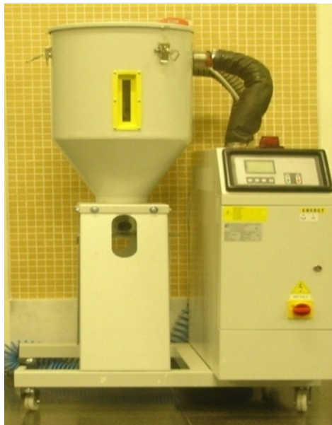
Figura I.22. Deshumidificador del laboratorio de materiales.
