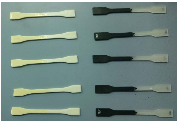
Figura IV.55. Probetas bimaterial empleadas en los ensayos de laboratorio.
