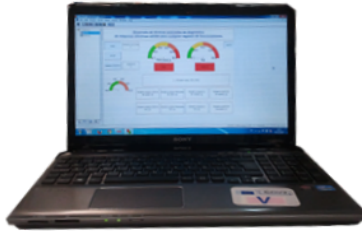
Figura 3.14: Ordenador utilizado en la automatización del banco de ensayos en la que se puede ver una ventana de la aplicación scada diseñada.
