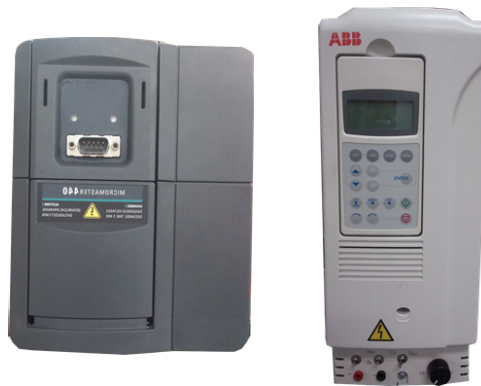
Figura 3.9: Convertidores de frecuencia Siemens M440 izquierda y ABB ACS800 – 01 – 0005 – 3 + E200 + L503 derecha utilizados en el banco de ensayos para controlar las máquinas de inducción ensayadas.
