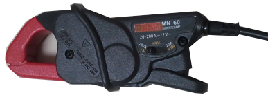
Figura 3.17: Pinzas amperimétricas utilizadas para la medida de corrientes.
