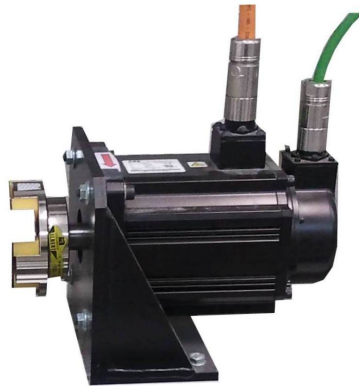
Figura 3.11: Máquina síncrona de imanes permanentes utilizada en el banco de ensayos.
