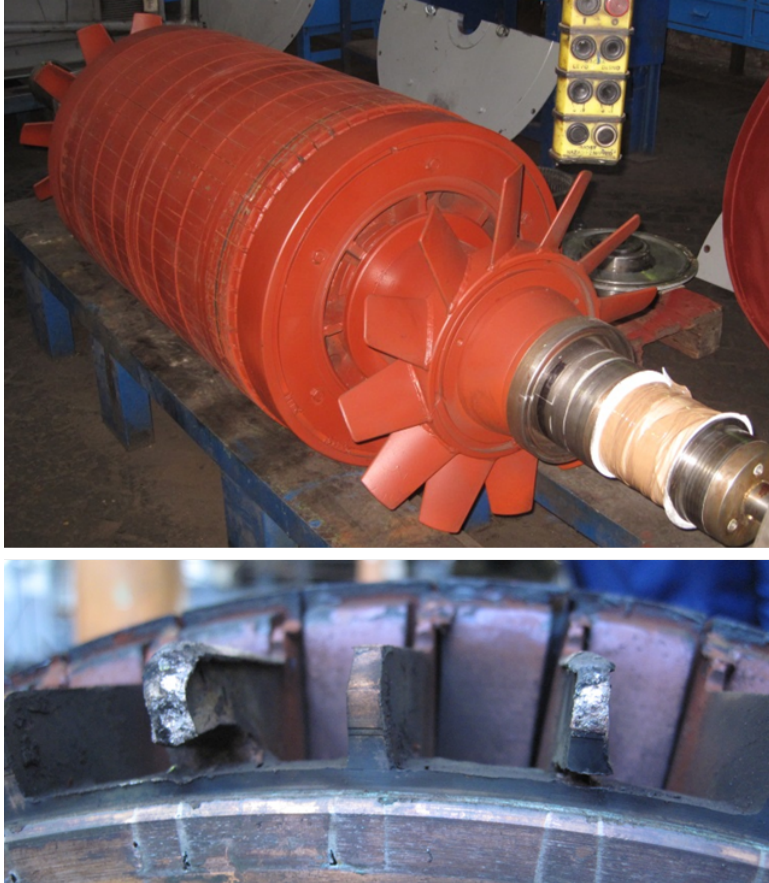
Figura 3.4: Rotor de la máquina de inducción de elevada potencia estudiada (superior) y detalle de la rotura total y rotura parcial de sendas barras de la máquina (inferior).
