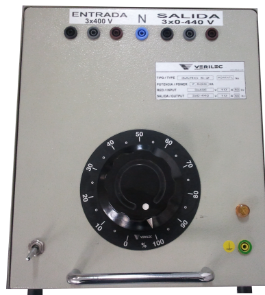
Figura 3.10: Autotransformador utilizado en los ensayos de las máquinas eléctricas de inducción.
