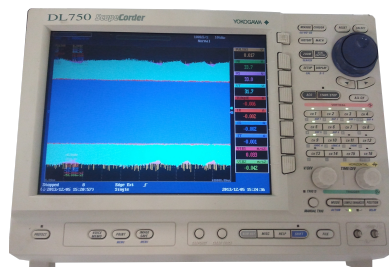
Figura 3.15: Osciloscopio digital utilizado para capturar las señales de cada ensayo.
