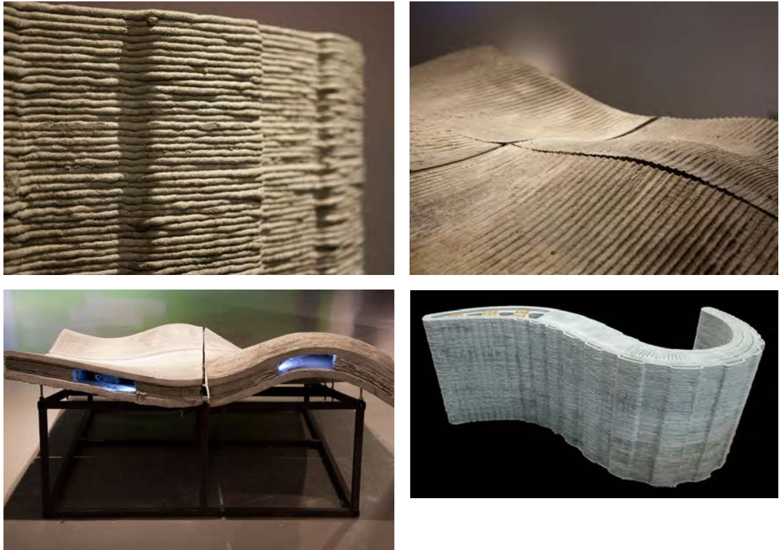
Imágenes de los materiales de hormigón creados con impresión 3D diseñados por Foster and Partners.
