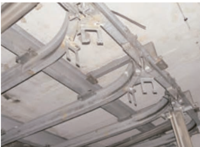
Imagen 26_Fotografías históricas de la nave 17-Colgaderos. Sistema de arrastre y colgado de reses en techo
