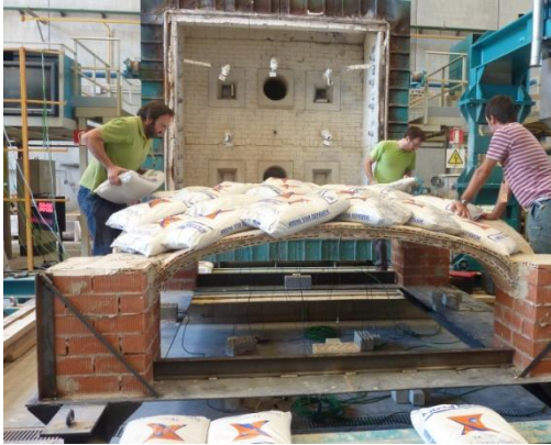
Ilustración 213.- Doctorando cargando la bóveda de dos roscas con los sacos de arena.
