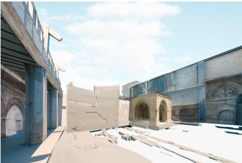
Ilustración 142 – Modelado del patio sur a partir de la nube de puntos. (Jordán Palomar, 2015).
