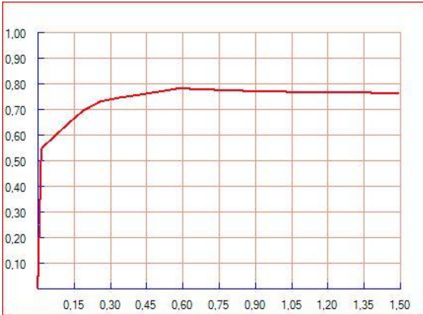
Ilustración 441– Desplazamiento en el eje x en relación al total de la carga aplicada en el punto 29702 del modelo Rell-M-522.
