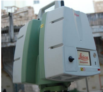
Ilustración 133 –Escáner láser utilizado en San Juan.(Jordán Palomar, 2015).
