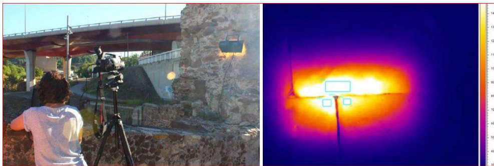
Ilustración 255 - Aplicación de la termografía activa en el Pont del diable en Martorell (Barcelona) (Tormo Esteve & Royo Pastor)
