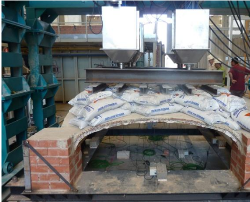
Ilustración 215 .- Carga con los cuatro pistones de la prensa hidráulica.
