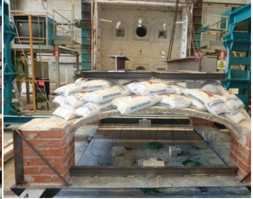
Ilustración 214 .- Colocación de los útiles de carga.
