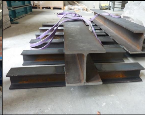
Ilustración 210.- Útiles de reparto de carga para las prensas.
