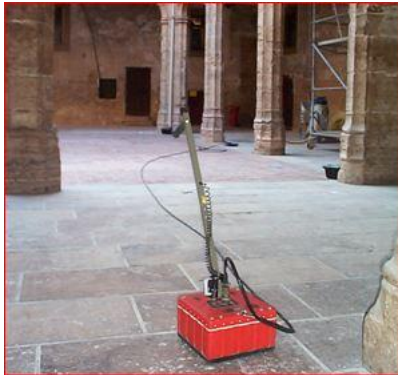
Ilustración 143 –Antena georradar de 400 MHz(García García F. , 2011)
