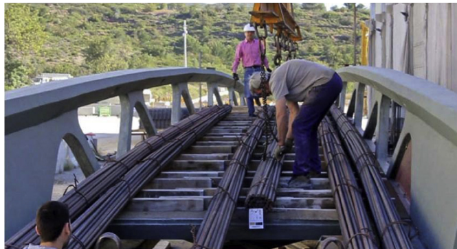
Figura 30. Paquetes de barras apoyados sobre maderas para la prueba de carga estática.
