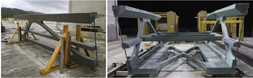
Figura 20. Prototipo de verificación del proceso de construcción.
