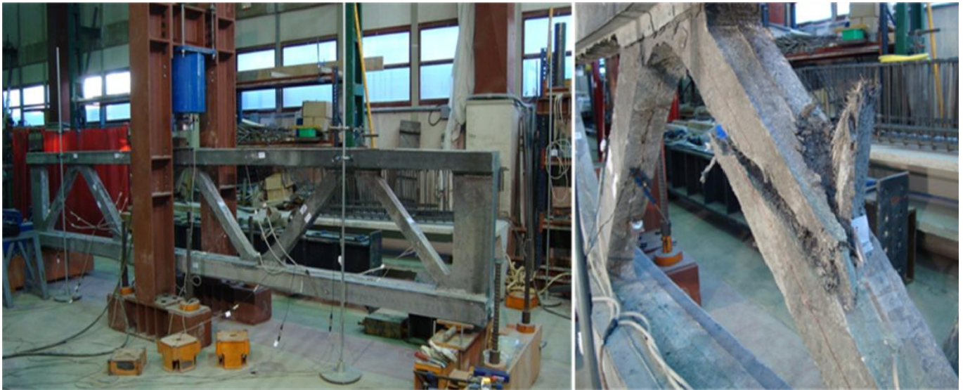
Figura 17. Configuración de ensayo del prototipo (izquierda) y rotura de la diagonal comprimida (derecha)
