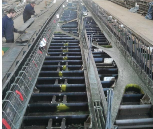
Figura 22. Esquema de hormigonado de la primera fase (izquierda); vista tras la finalización de la primera fase de fabricación (derecha)
