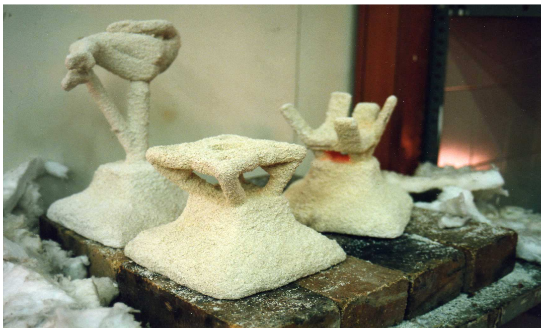
Ilustración 60. Estado de la pieza después del descere y la cocción.
