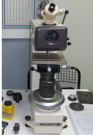
Figura 4.21. Microdurómetro WOLPERT V-TESTOR 2
