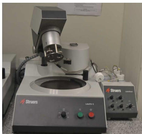
Figura 4.10. Equipo de pulido de brazo modelo Labopol-5 de Struers
