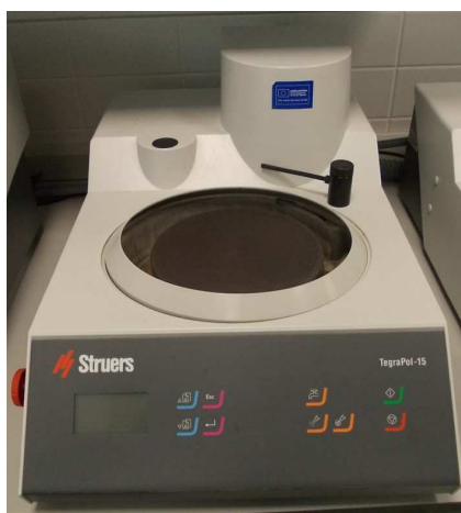
Figura 4.9. Equipo de pulido modelo TegraPol-15 de Struers
