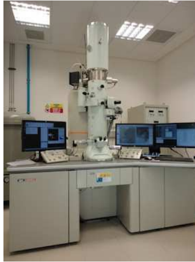
Figura 4.16. Microscopio Electrónico de Transmisión de Emisión de Campo de 200 kV Modelo JEM 2100F de la casa JEOL
