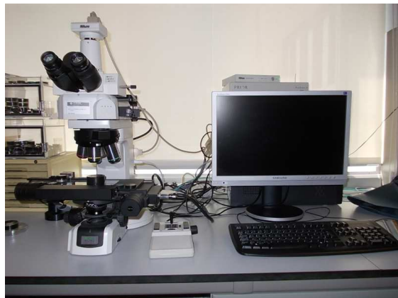
Figura 4.12. Microscopio óptico NIKON ECLIPSE LV100
