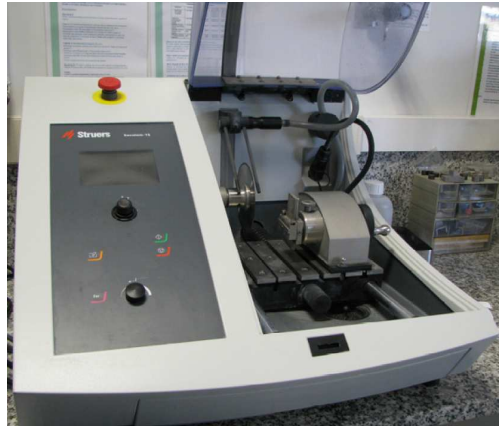
Figura 4.7. Cortadora de precisión Secotom 15 de Struers
