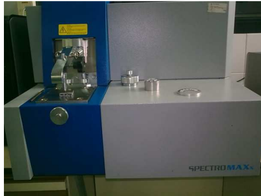
Figura 4.1. Espectrofotómetro de emisión por chispa SPECTROMAXx del Instituto Tecnológico Metalmecánico de Valencia (AIMME)
