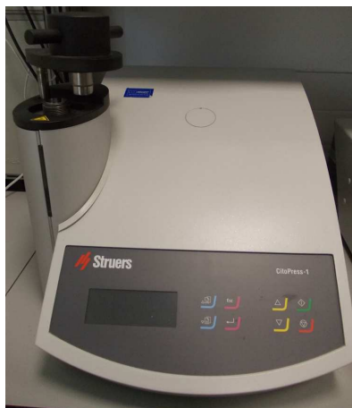
Figura 4.8. Equipo de embutición modelo CitoPress-1 de Struers
