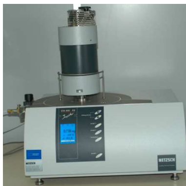
Figura 4.17. Calorímetro diferencial de barrido modelo STA 449 F3 Jupiter DTA-TG de NETZSCH
