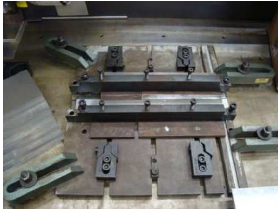
Figura 4.6. Sistema de sujeción de las chapas de aluminio para soldarlas por fricción-agitación (FSW)
