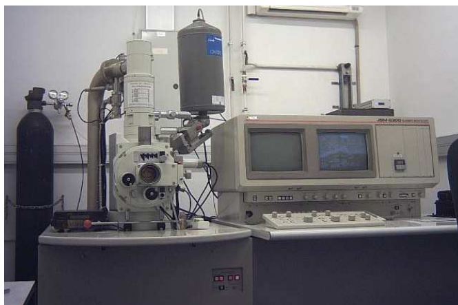
Figura 4.13. Microscopio electrónico de barrido JEOL JSM 6300.
