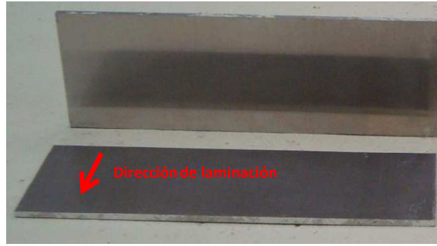
Figura 3.4. Corte de las placas para ser soldadas por fricción-agitación. Todas las soldaduras serán perpendiculares a la dirección de laminación
