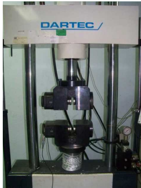
Figura 4.20. Máquina de ensayos universal DARTEC RK 9500
